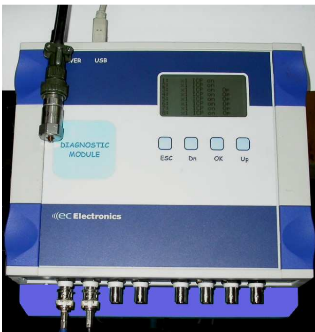
Rys.3. Moduł do diagnostyki on-line przekładni zębatej
