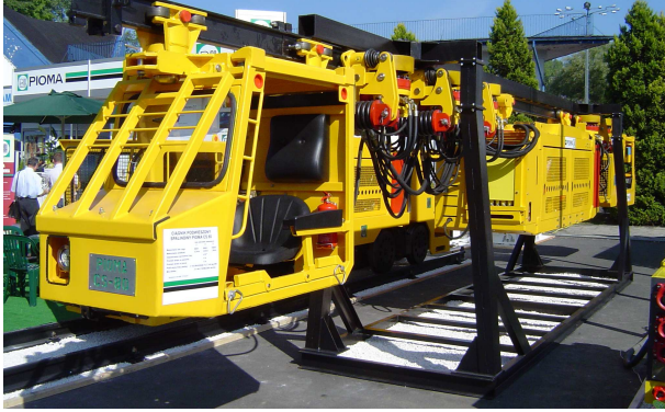
Rys.4. Ciągniki kolejek podwieszanych CS-80 (z lewej) i CS-120 (z prawej)
