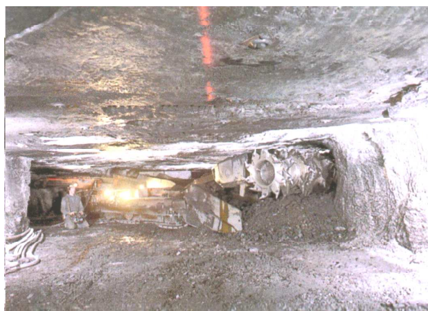
Rys.5. Widok kombajnu urabiającego liniowo 14CM firmy Joy podczas pracy przy drążeniu chodnika węglowego i eksploatacji węgla
