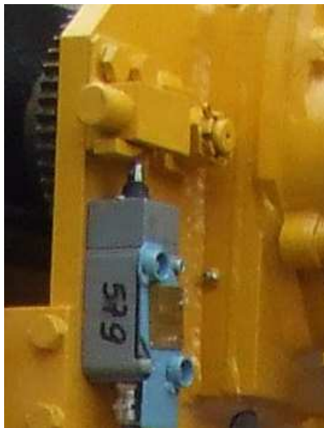
Rys.9. Wyłącznik krańcowy: a) model 3D, b) obiekt rzeczywisty
