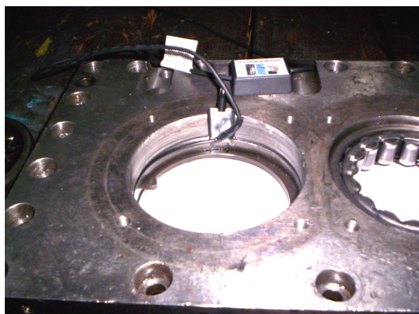
Rys.2. Sposób montażu kabla piezolaminatowego jako czujnika drgań w przekładni zębatej
