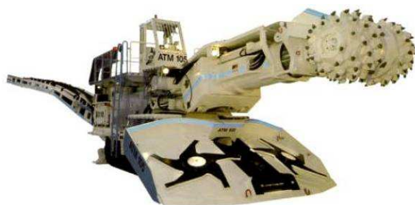
Rys.3. Kombajn chodnikowy ramionowy ciężki typu ATM ICUTROC, stosowany do drażenia wyrobisk tunelowych w skałach twardych
