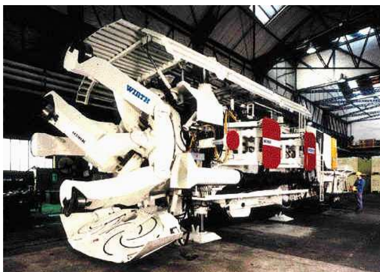
Rys.8. Widok kombajnu CMM firmy WIRTH urabiającego metodą tylnego podcinania
