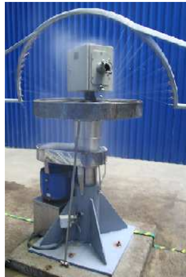
Rys.3. Stanowiska do badań stopnia ochrony IP przed wnikaniem ciał stałych i wody
