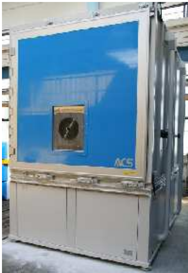
Rys.3. Stanowiska do badań stopnia ochrony IP przed wnikaniem ciał stałych i wody
