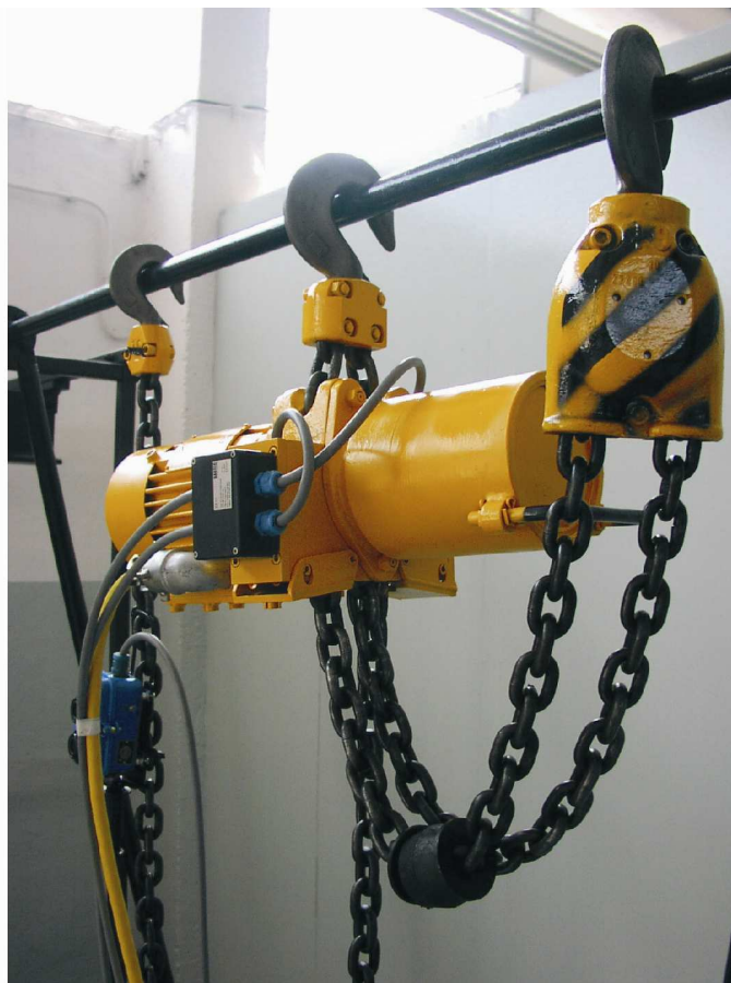
Rys.1. Elektryczny wciągnik łańcuchowy EWŁ-3/6A.
