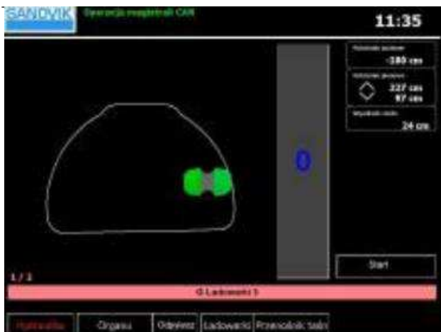
Rys.4. Automatyczny system VAB oraz układ automatycznej kontroli profilu urabiania firmy Sandvik Voest Alpine GmbH Bergtechnik
