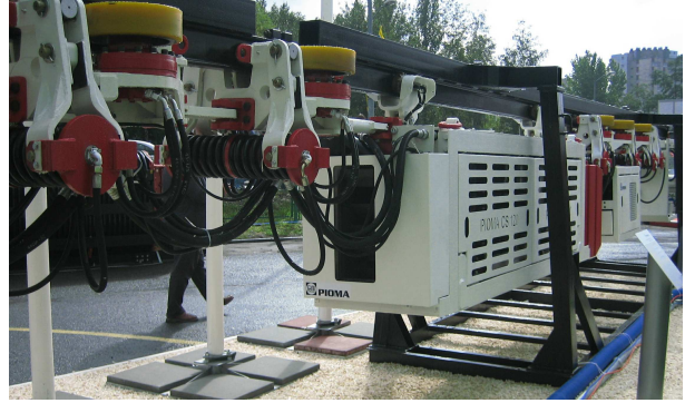
Rys.4. Ciągniki kolejek podwieszanych CS-80 (z lewej) i CS-120 (z prawej)
