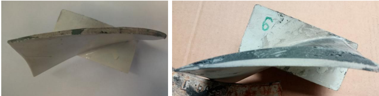
Rys. 9. Łopátka wirnika przed i po naklejeniu nakładki korygującej [opracowanie własne]
