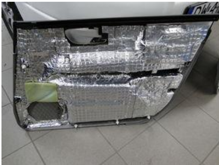
Rys. 5. Obudowanie drzwi pojazdu matą butylową [9]
