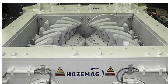
Rys. 11. Kruszarki dwuwalcowe dużej wydajności Hazemag serii HCS [23]: a kruszarka, b – strefa rozdrabniania z tarczami rozdrabniającymi
