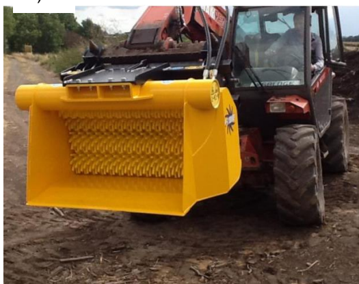
Rys. 15. Przykłady eksploatacji kruszarek: a – zainstalowanej na koparce [27], b – zainstalowanej na ładowarce [29]
