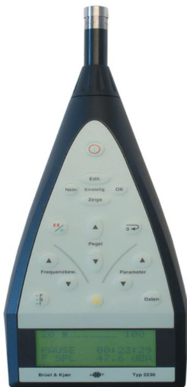
Rys. 1. Miernik poziomu dźwięku Brüel & Kjær typu 2236 [10]
