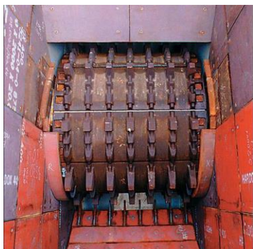
Rys. 9. Strefy kruszenia kruszarek jednowalcowych: a – kruszarki firmy FAM [32], b – kruszarki firmy McLanahan [35]
