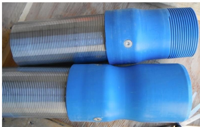
Rys. 23. Filtry szczelinowe stosowane przy wydobywaniu uranu
