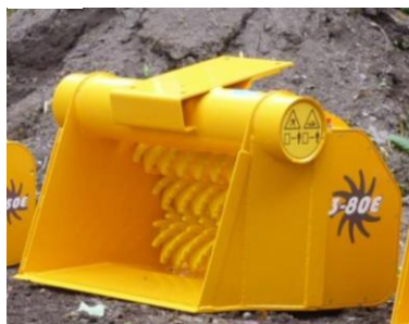
Rys. 14. Inne zastosowanie kruszarek: a – jednowalcowa łyżka rozdrabniająca [28], b - trójwalcowa łyżka rozdrabniająca [30], walec rozdrabniający [29]
