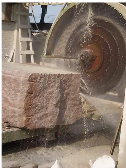
Rys. 7. Cięcie bloku granitu na mokro [10]
