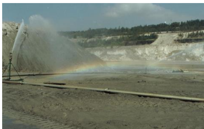
Rys. 8. Zraszanie skarpy czołowej w kopalni Turów [11]
