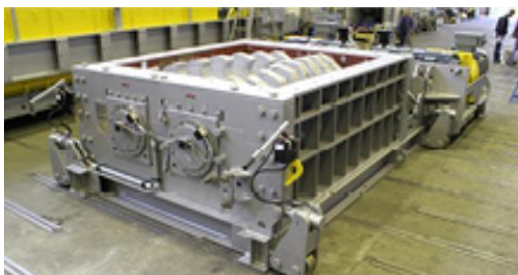
Rys. 11. Kruszarki dwuwalcowe dużej wydajności Hazemag serii HCS [23]: a kruszarka, b – strefa rozdrabniania z tarczami rozdrabniającymi
