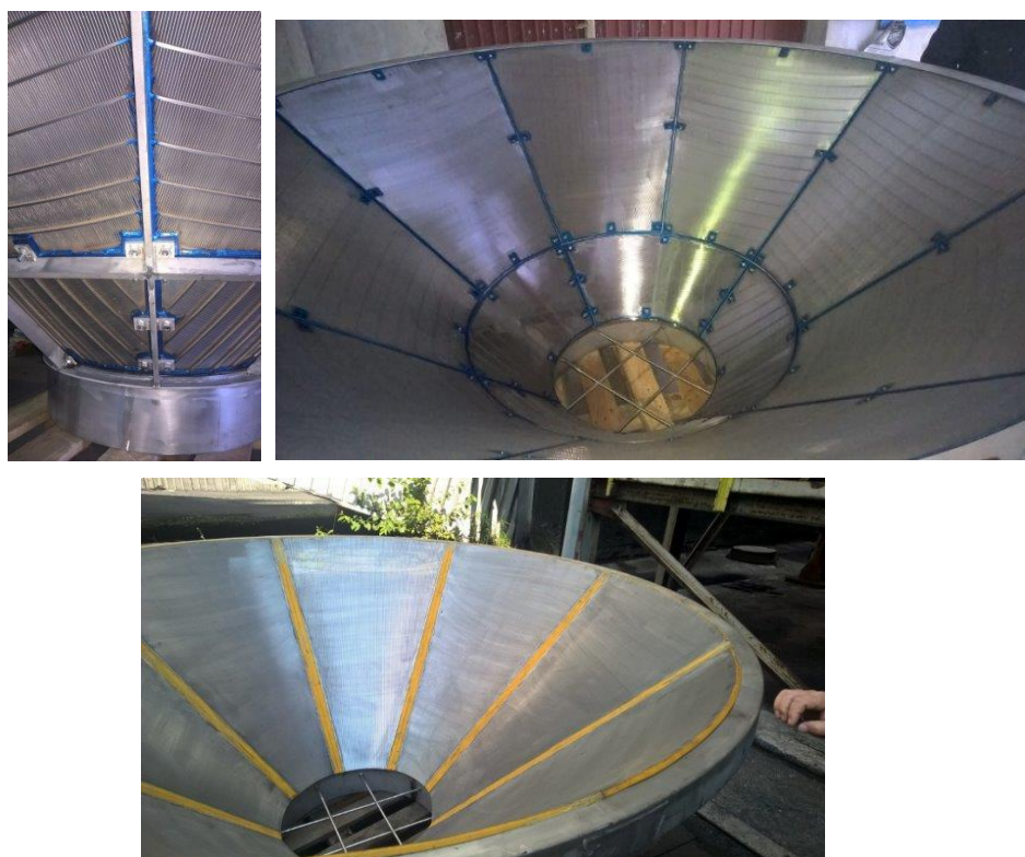
Rys. 13. Wkłady modułowe odśrodkowych sit odwadniających (OSO)
