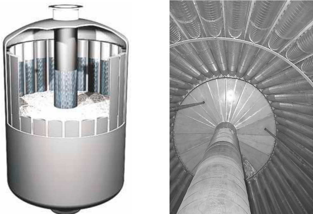
Rys. 18. Reaktory do reformingu ropy z zabudowanymi sitami szczelinowymi
