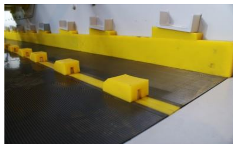
Rys. 7. Idea zabudowy pokładu sit szczelinowych w systemie klinowania
