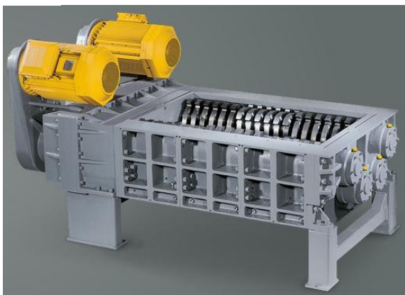
Rys. 13. Rozwiązanie konstrukcyjne kruszarki czterowalcowej: a – widok kruszarki, b – widok strefy rozdrabniania [14]
