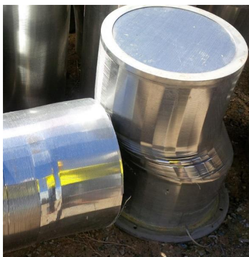
Rys. 22. Uszkodzony filtr kolumny SNK
