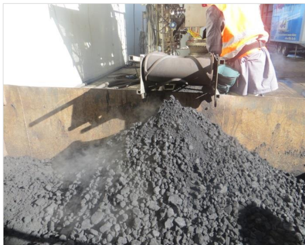
Rys. 9. Zawartość wilgoci niezwiązanej placka filtracyjnego 8% w/w (źródło: opracowanie własne)
