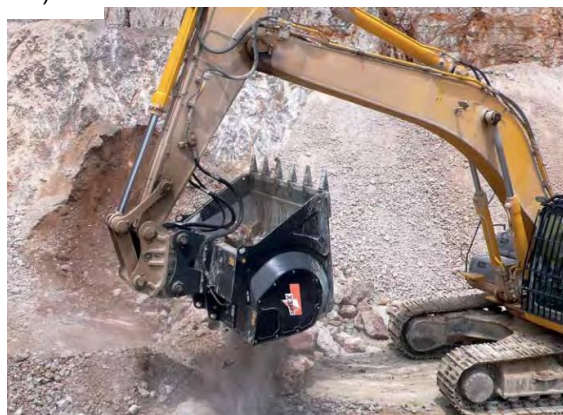
Rys. 15. Przykłady eksploatacji kruszarek: a – zainstalowanej na koparce [27], b – zainstalowanej na ładowarce [29]
