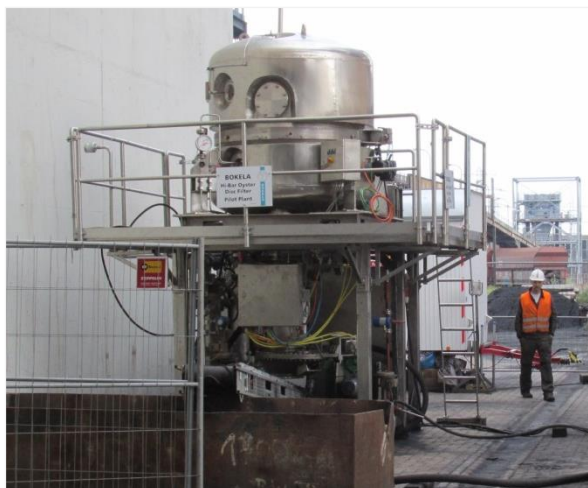
Rys. 8. Jednostka pilotowa HiBar (1m 2 filtr tarczowy) na płuczce węglowej Auguste Victoria (RAG)
