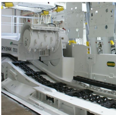
Rys. 8. Kruszarki jednowalcowe: a – ścianowa [7], b - rozbrylacz [33]
