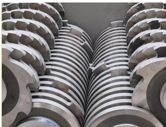
Rys. 13. Rozwiązanie konstrukcyjne kruszarki czterowalcowej: a – widok kruszarki, b – widok strefy rozdrabniania [14]
