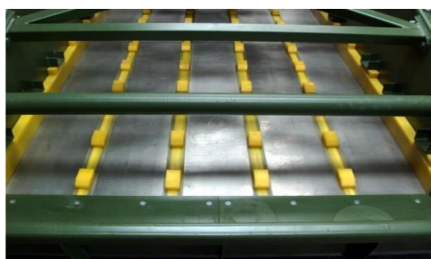
Rys. 7. Idea zabudowy pokładu sit szczelinowych w systemie klinowania
