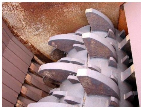
Rys. 9. Strefy kruszenia kruszarek jednowalcowych: a – kruszarki firmy FAM [32], b – kruszarki firmy McLanahan [35]
