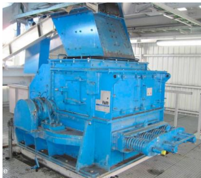
Rys. 7. Kruszarki jednowalcowe: a – firmy FAM, [31], b – firmy Cogar [32]
