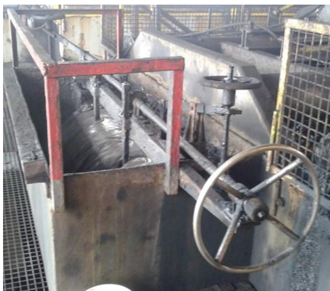
Rys. 1. Ręczny system sterowania i regulacji poziomu pulpy flotacyjnej (grubości piany)
