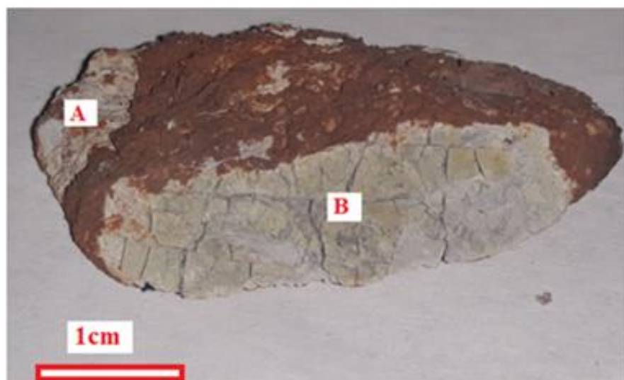
Rys. 7. Widok spalonego ziarna węgla 33/34.1 z barierą haloizytową (brązowy kolor) (zarówno pod powierzchnią warstwy haloizytu (A), jak i w środku ziarna (B) jest tylko popiół z całkowicie spalonego węgla)
