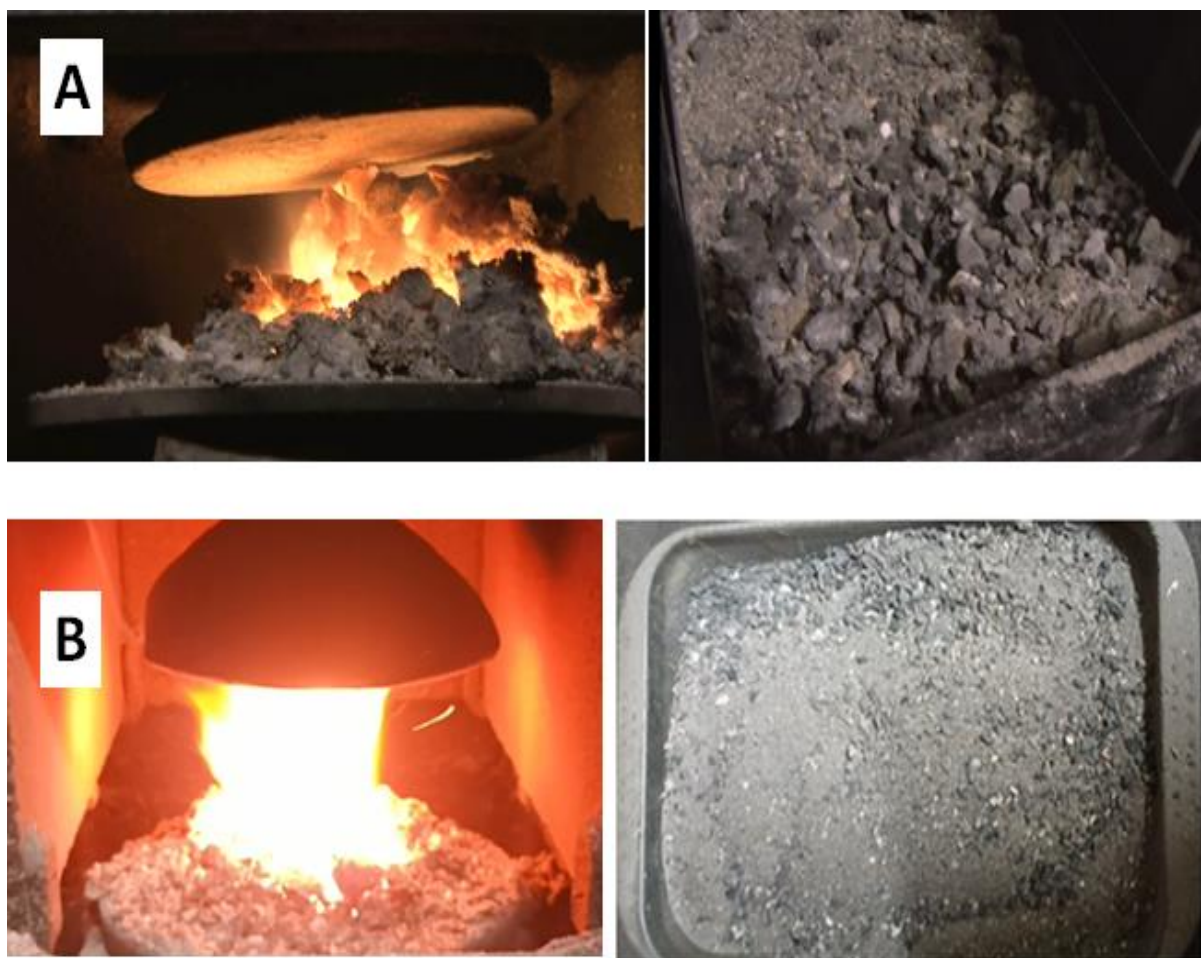
Rys. 8. Porównanie spalania w kotle retortowym węgla klasy 33/34.1 w stanie naturalnym (A) oraz tego samego węgla pokrytego haloizytem (B) (z prawej strony widoczny popiół z obu prób; jasny kolor komory spalania (B) wskazuje na prawidłowy przebieg procesu spalania w przeciwieństwie do pokrytej sadzą komory (A)) [2]
