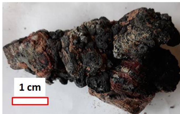
Rys. 4. Aglomerat koksowy ziaren węgla z ZG Brzeszcze utworzony w czasie procesu spalania [2]
