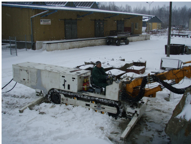
Rys.1. Małogabarytowy wóz wiertniczy MWW-1: a) w pozycji transportowej, b) w pozycji wiercenia
