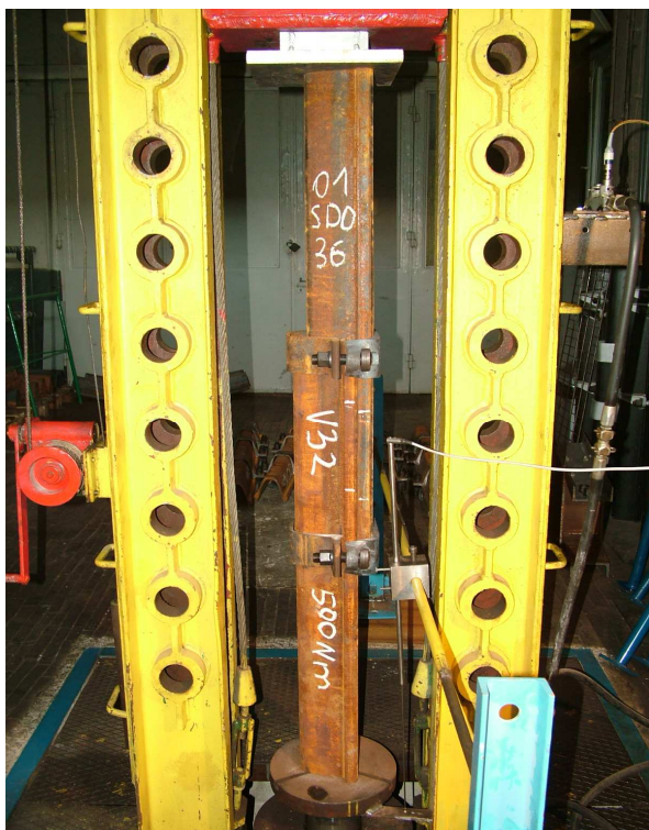
Rys.2. Sposób badania złącza ciernego stalowej podatnej obudowy górniczej z dwoma strzemionami
