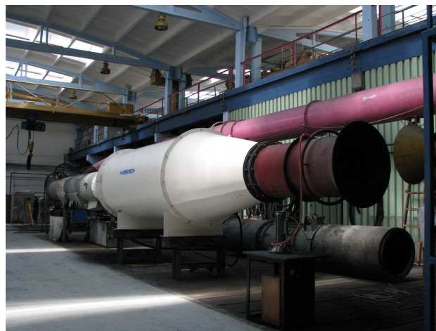
Rys.5. Stanowisko badawcze do badania skuteczności wytrącania pyłu
