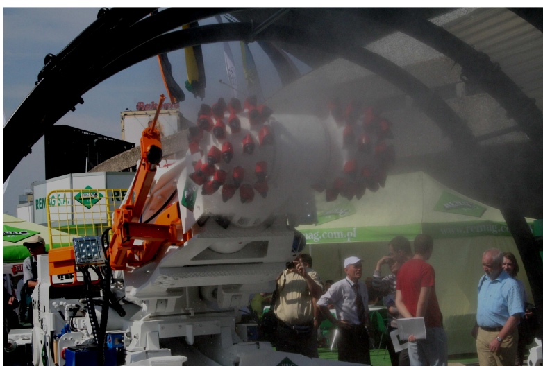
Kombajn chodnikowy R-200 produkcji REMAG SA wyposażony w nowoczesne rozwiązanie systemu zraszającego powietrzno-wodnego zaprojektowane przez Instytut Techniki Górniczej KOMAG
