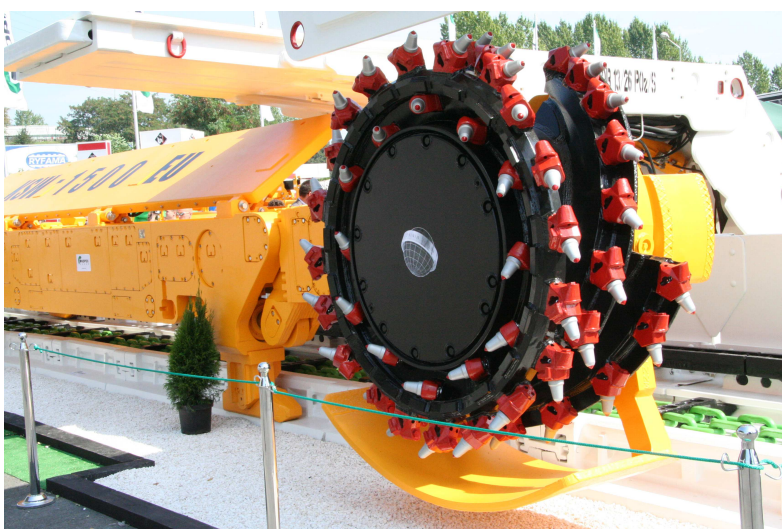
Ramię kombajnu ścianowego z elektrycznym napędem posuwu KSW-1500 EU
