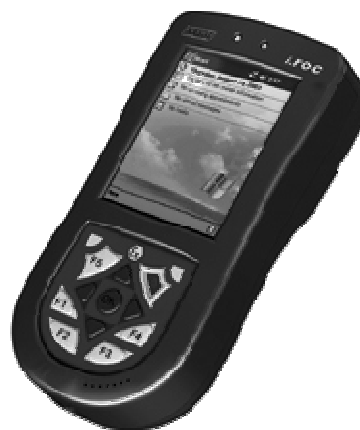
Rys.5. PDA spełniający wymogi Dyrektywy ATEX [źródło: opracowanie własne]
