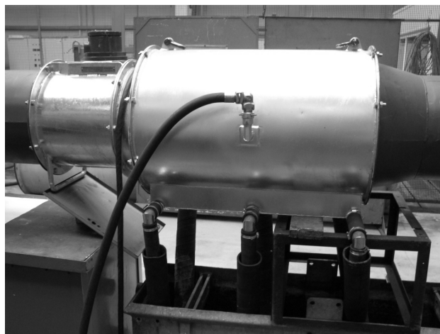
Rys.3. Prototyp urządzenia odpylającego UO-400-2 na stanowisku badawczym [2]
