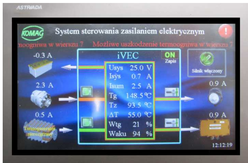
Rys.4. Widok panelu HMI podczas działania systemu [10]
