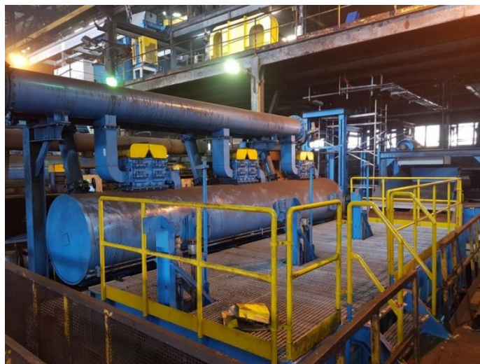
Rys. 8. Osadzarka miałowa OM20 KWK Budryk [źródło: opracowanie własne]
