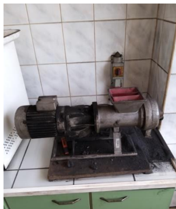
Rys. 6. Kruszarzka laboratoryjna (opracowanie własne)
