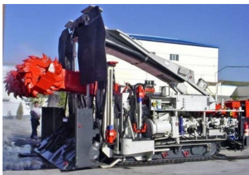
Rys. 4. Podpory stropu różnej konstrukcji w kombajnach typu Bolter-Miner [18, 19]
