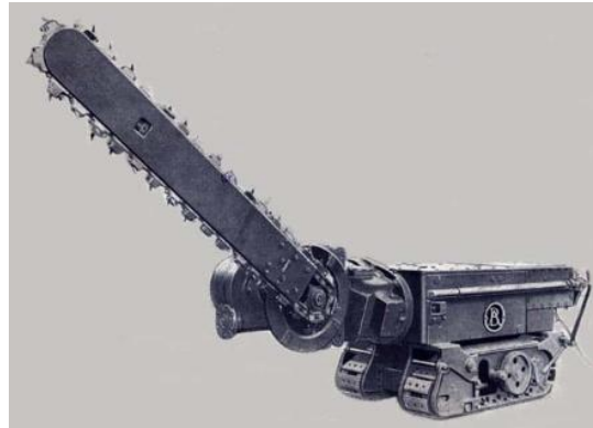
Rys. 8. Wrębiarka chodnikowa firmy AB 4 5
