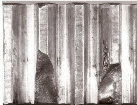
Rys. 2. Jednoczesne zmęczeniowe złamania częściowe dwóch zębów przekładni zębatej. Widoczne również zmęczeniowe wykruszenia warstwy wierzchniej współwystępujące ze zmęczeniowym wyłamaniem części zęba (po prawej stronie) [opracowanie własne]
