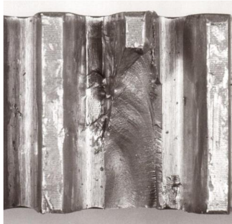
Rys. 1. Obraz powierzchni eksploatacyjnego przełomu zęba przekładni zębatej. Widoczne ogniska zmęczeniowe, linie przystankowe pęknięcia zmęczeniowego i strefa dołomu zęba [opracowanie własne]
