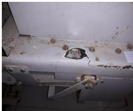
Rys. 21. Układ tensometrów na belce górnej ramy CF25(TP)
