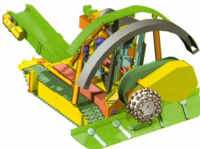
Rys. 9. Agregat chodnikowy AVSA wyposażony w mechaniczną obudowę tymczasową [21]
