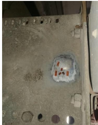
Rys. 25. Układ tensometrów na wsporniku w położeniu 5
