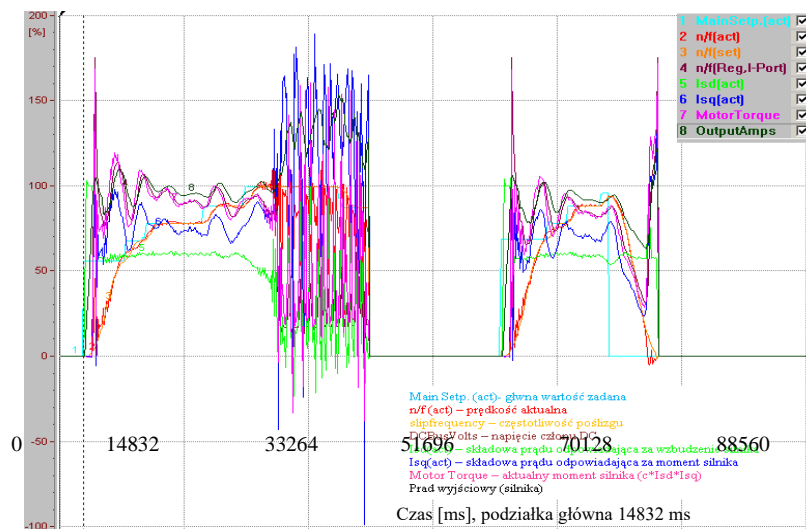
Rys. 1. Badania przenośnika samojezdnego PGOT - praca przenośnika odbierającego – jazda w kierunku od skarpy do koparki, warunki atmosferyczne: zima, mroź temperatura -18^{\circ}\text{C} . [opracowanie własne na podstawie [1]]
