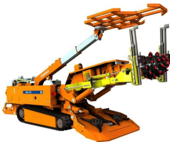
Rys. 5. Kombajn chodnikowy z tymczasową podporą stropu [22]
