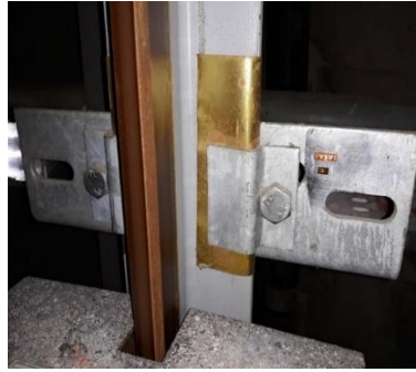
Rys. 25. Układ tensometrów na wsporniku w położeniu 5
