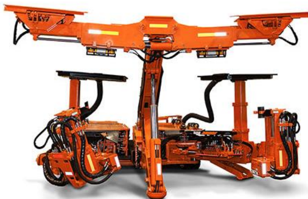
Rys. 3. Samojezdna kotwiarka firmy J.H.Fletcher z hydrauliczną podporą stropu [16]
