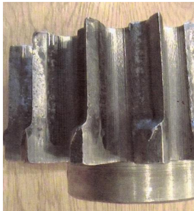
Rys. 5. Widok skrajnego stopnia zużycia ściernego zębów koła zębatego pracującego na niepełnej szerokości koła w warunkach intensywnego oddziaływania pyłu mineralnego [opracowanie własne]
