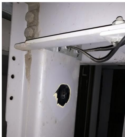
Rys. 22. Układ tensometrów na cięgnie ramy kabiny CF25(TP)
