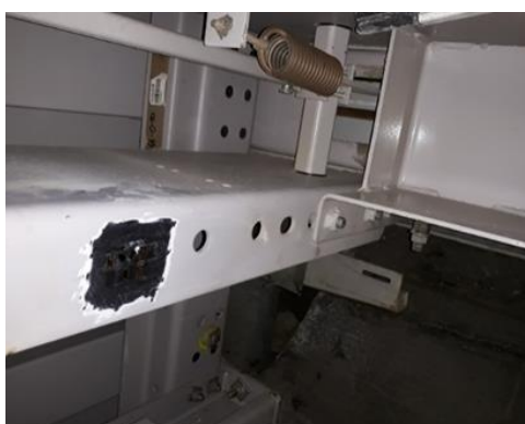
Rys. 23. Układ tensometrów na belce dolnej ramy kabiny CF25(TP)
