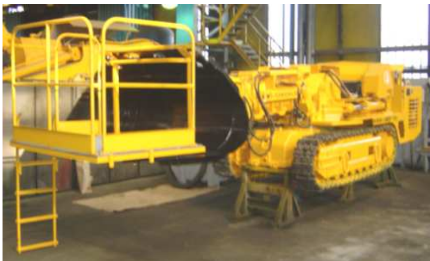
Rys.7. Pomost roboczy zabudowany w czerpaku ładowarki ŁBT-1200EH/LS-A
