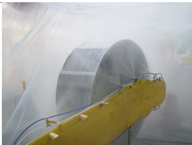
Rys.2. Badania stanowiskowe instalacji powietrzno-wodnej z zastosowaniem makiety kombajnowego ramienia i organu urabiającego
