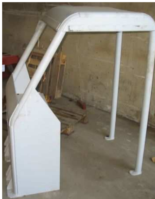
↑ Rys.4. Kabina operatora ładowarki ŁBT-1200EH/LAS-A: a) model, b) obiekt rzeczywisty
