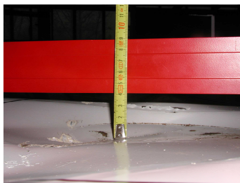
Rys.11. Pomiar maksymalnego ugięcia po badaniach stanowiskowych
