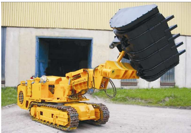
Rys.15. Ładowarka bocznie wysypująca ŁBT-1200EH/LS-A z wysięgnikiem teleskopowym
