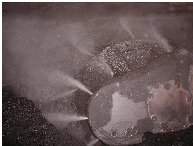
Rys.12. Działająca zraszająca instalacja powietrzno-wodna na kombajnie KSW-460NE pracującym w ścianie nr W-9 w kopalni „Pniówek”
