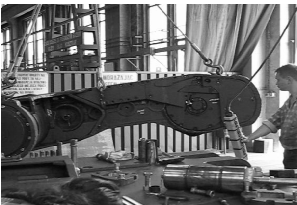
Rys.1. Przebieg czynności demontażu ramienia kombajnu ścianowego: a) w warunkach rzeczywistych podczas likwidacji ściany, b) w wytwórni
