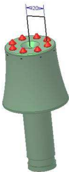
Rys.2. Schemat przedstawiający ramię działające na obrót narzędzia
