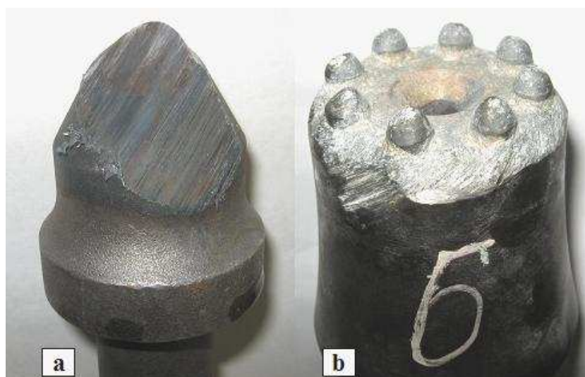
Rys.8. Widok noży po przeprowadzonych próbach urabiania: a) nóż styczno-obrotowy po urobieniu próbki na drodze około 35 m, b) nóż koronowy po urobieniu próbki na drodze ponad 650 m
