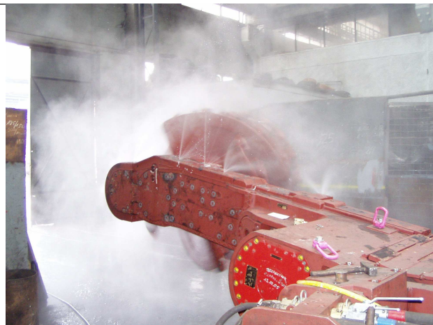
Rys.11. Próby powierzchniowe zraszającej instalacji powietrzno-wodnej na powierzchni kopalni „Pniówek”
