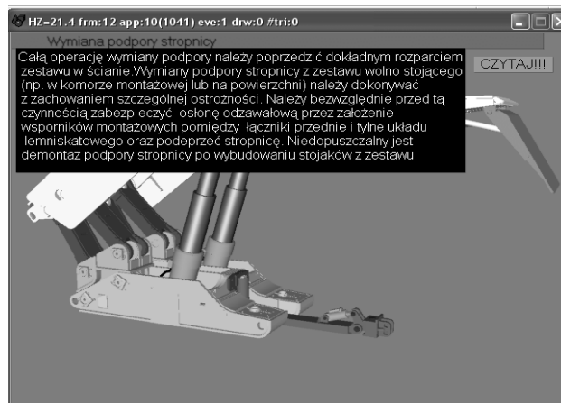
Rys.5. Zastosowanie dodatkowych opisów w symulacji montażu/demontażu
