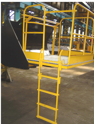
Rys.7. Pomost roboczy zabudowany w czerpaku ładowarki ŁBT-1200EH/LS-A
