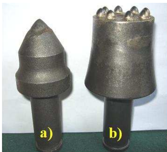
Rys.4. Widok narzędzi wytypowanych do badań porównawczych: a) nóż styczno-obrotowy RM8-22/53, b) nóż koronowy
