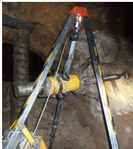
Rys. 4. Urządzenie drażące wyrobisko ratunkowe [4]
