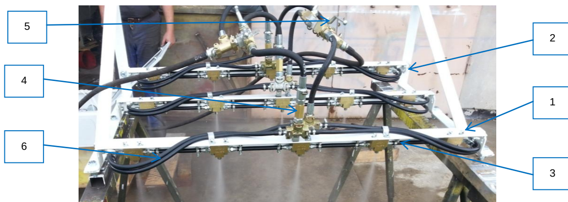
Rys. 11. Zespół zraszający podczas prób ruchowych u producenta [7]
