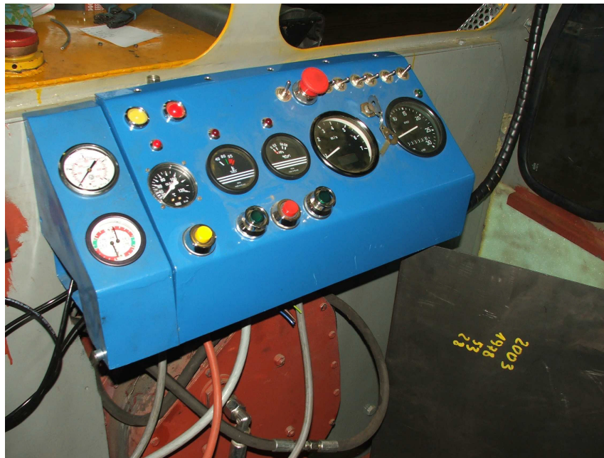
Rys. 9. Pulpit sterowniczy lokomotywy WLP-50EM [7]
