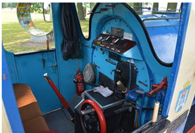
Rys. 1. Widok wnętrza kabiny lokomotywy WLs-40 [1]
