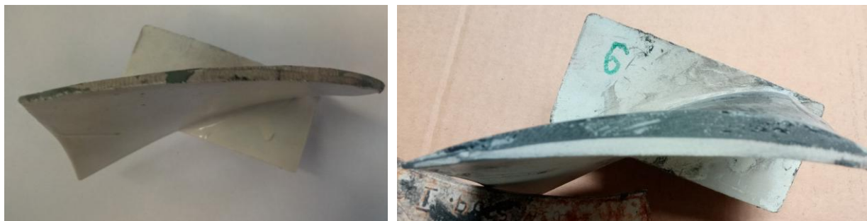
Rys. 9. Łopaska wirnika przed i po naklejeniu nakładki korygującej [opracowanie własne]
