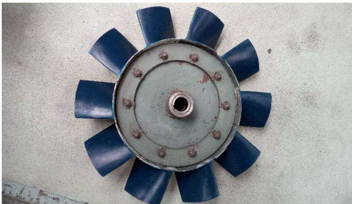
Rys. 10. Zmodyfikowany wirnik wentylatora \phi 630 po procesie wyważania [opracowanie własne]
