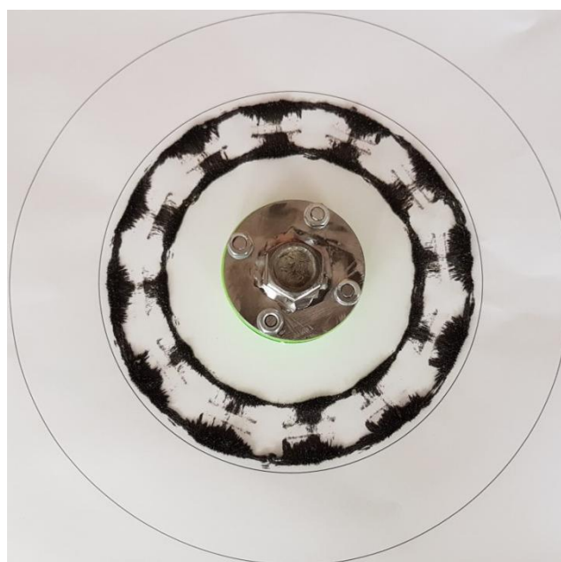
Rys. 17. Linie sił pola magnetycznego w hamulcu – pary przeciwsobne [2]
