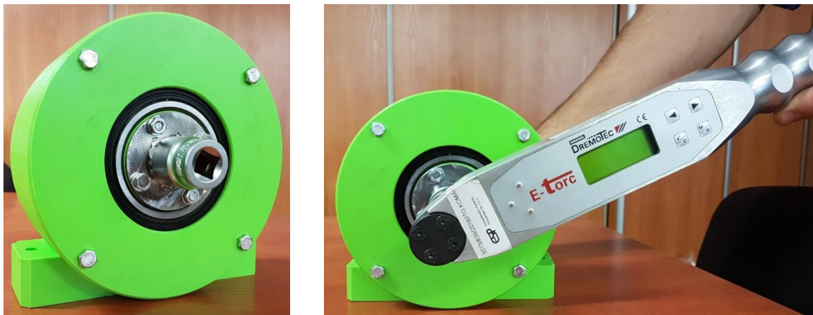
Rys. 13. Próby doświadczalne hamulca [2]
