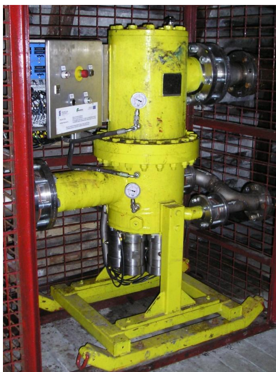
Rys. 1. Filtr samoczyszczący FS-60 produkcji KOPEX Machinery [8]
