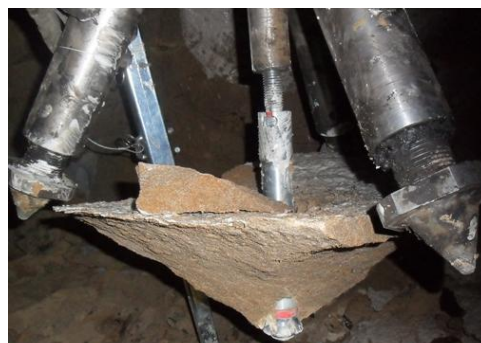
Rys. 8. Wyrwany stożek skalny [4]
