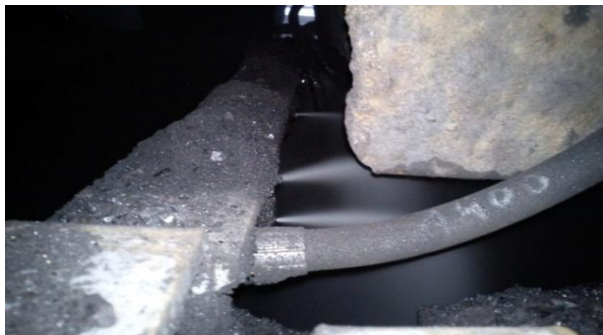
Rys. 8. System wytwarzający strumienie powietrzno-wodne, podczas prób [7]
