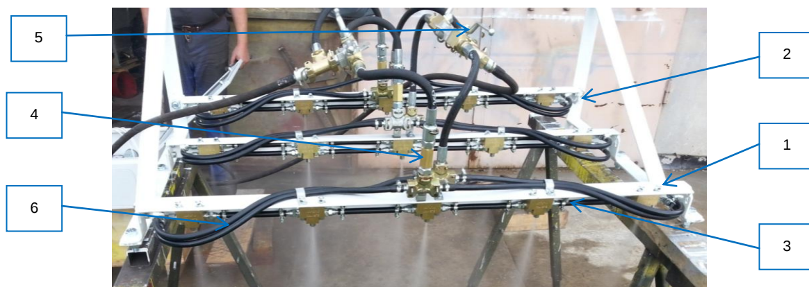
Rys. 11. Zespół zraszający podczas prób ruchowych u producenta [7]
