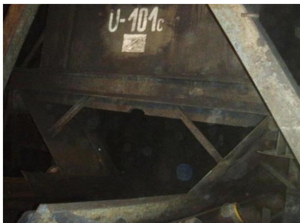
Rys. 2. Obudowany przesyp przenośnika stalowo-członowego nr U-101C [7]
