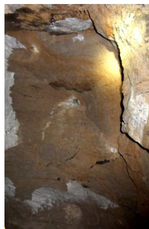
Rys. 8. Wyrwany stożek skalny [4]
