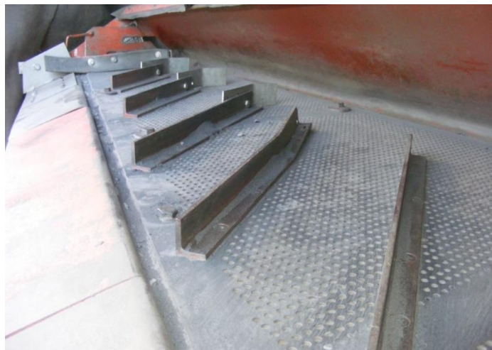
Rys.2. Płyta robocza powietrznego stołu koncentracyjnego typu FGX-1 [źródło: fotografia własna – Wojciech Sobko]
