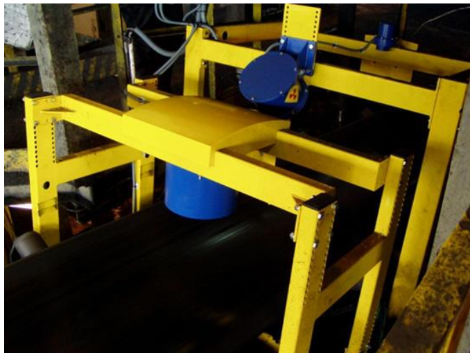
Rys.14. System ciągłego pomiaru parametrów jakości węgla WILPO C 532 hc [źródło: opracowanie własne]
