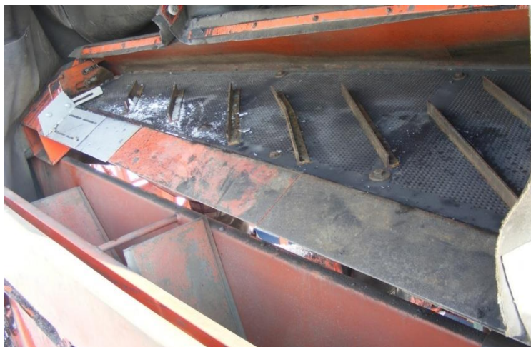
Rys.1. Płyta robocza powietrznego stołu koncentracyjnego typu FGX-1 [źródło: fotografia własna – Wojciech Sobko]
