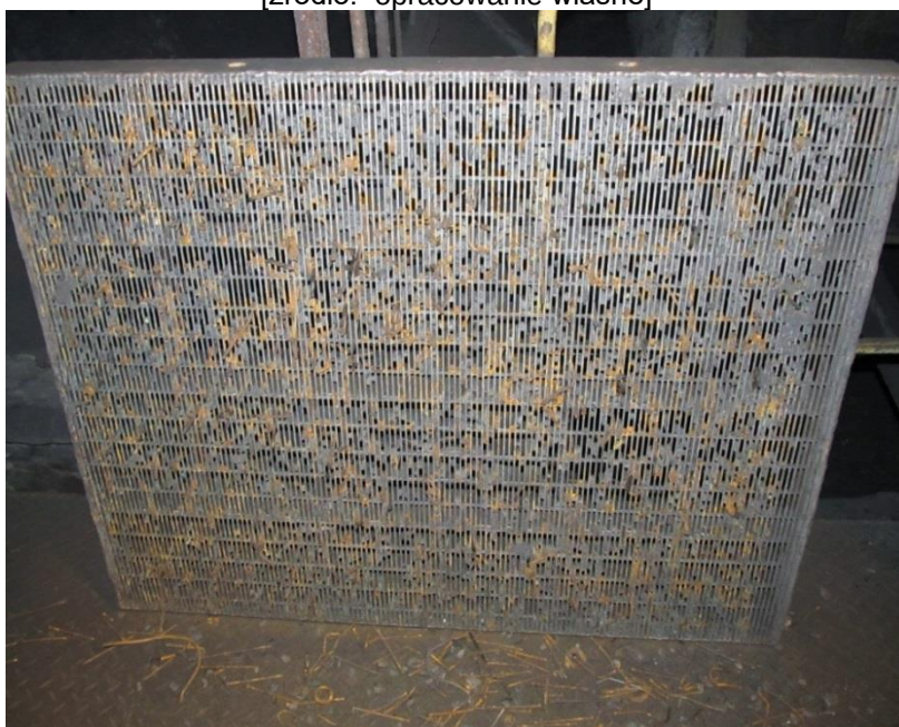
Rys.4. Pokład sitowy osadzarki przed zainstalowaniem separatora elektromagnetycznego [źródło: opracowanie własne]
