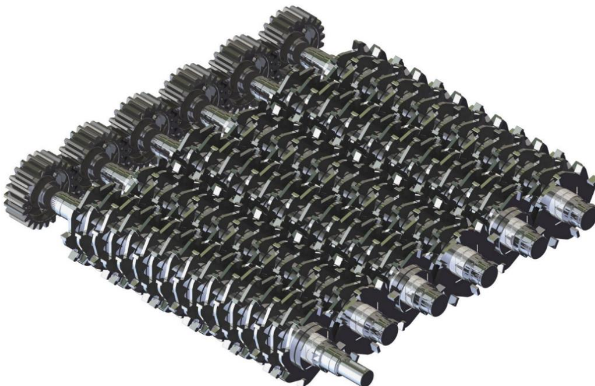
Rys.12. Zespoły krążków osadzone na wałach roboczych [17]
