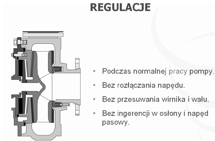
Rys.5. Przekrój przez komorę roboczą pompy millMAX
