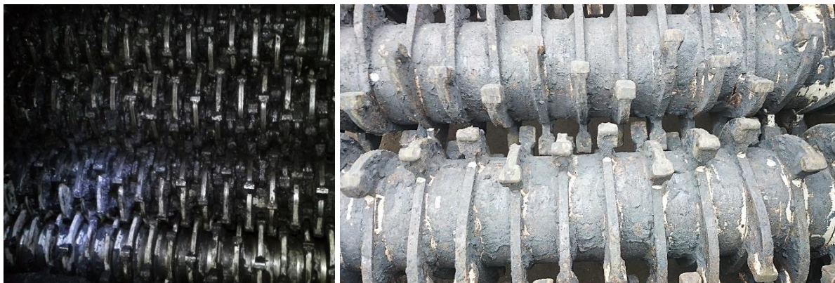
Rys.17. Zespoły krążków osadzone na wałach roboczych [17]
