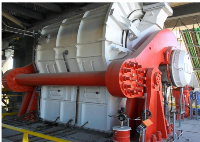
Rys.13. Młyn walcowy HOROMILL firmy Fives FCB [19]
