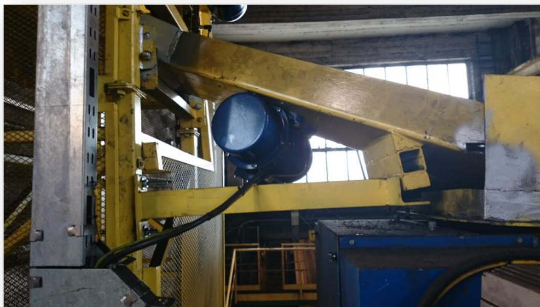
Rys.7. Podajnik wibracyjny PW [2]
