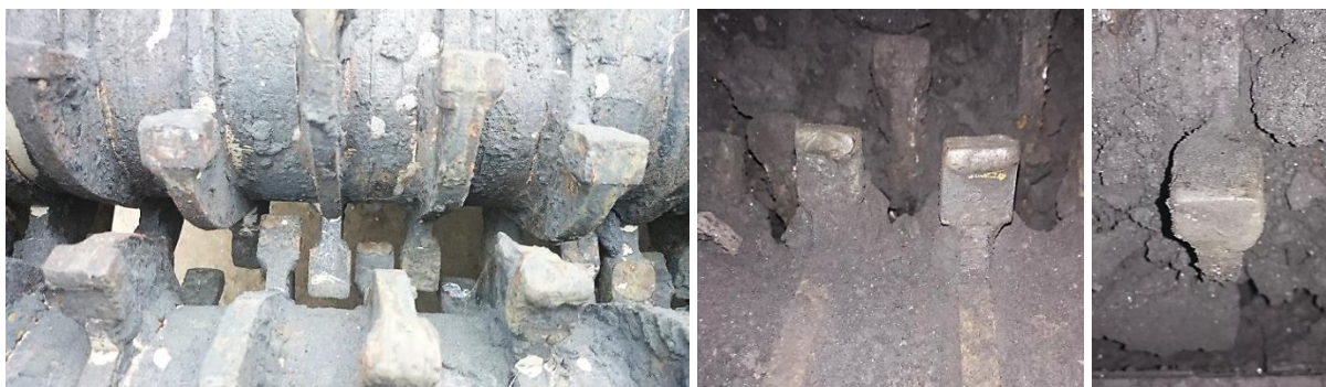
Rys.18. Elementy robocze krążków zębatach po półrocznej eksploatacji, z widocznym napawaniem na ostrzach [17]
