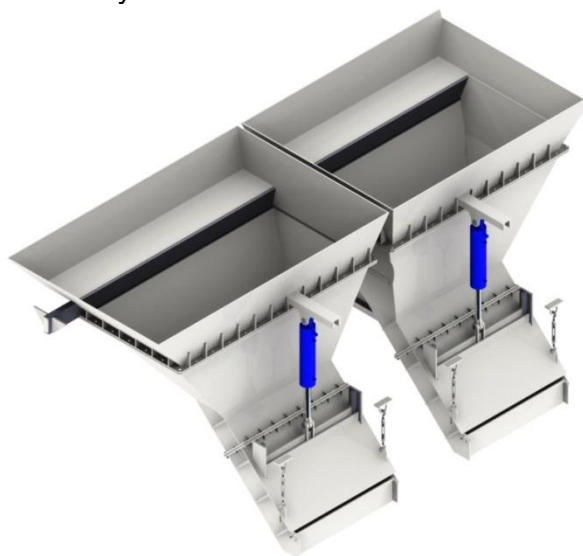
Rys.7. Układ doprowadzenia nadawy na osadzarkę OM30 typu KOMAG [3].
