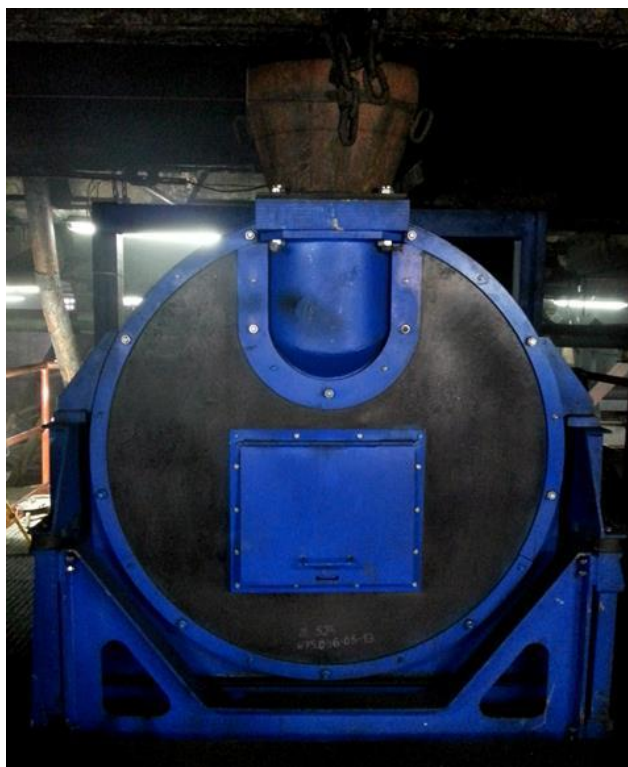
Rys.15. Wirówka odwadniająca WOW 1.3 F NG [źródło: opracowanie własne]
