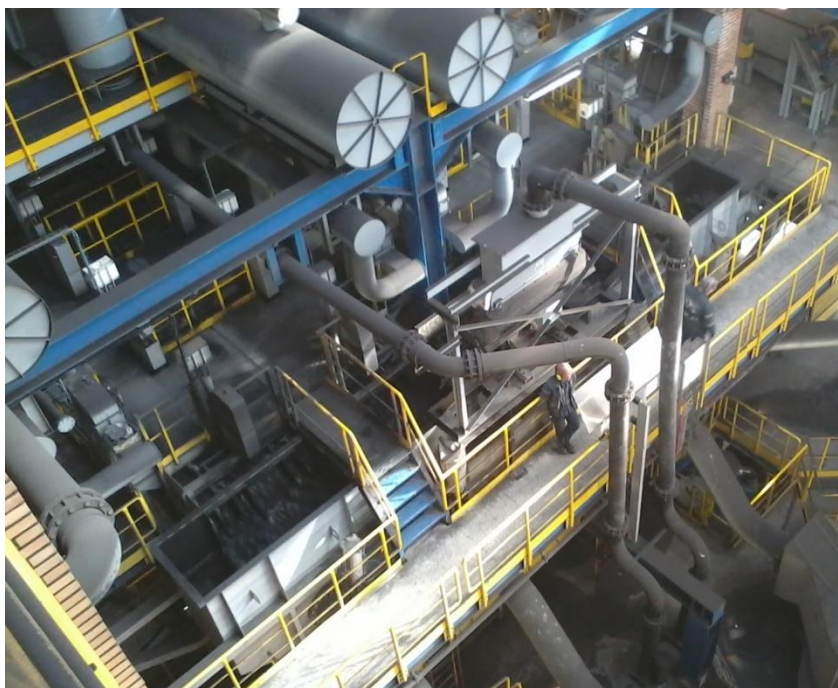
Rys.4. Osadzarki wodne pulsacyjne OMD3-4x7,5 typu PROREM (źródło: materiały własne)
