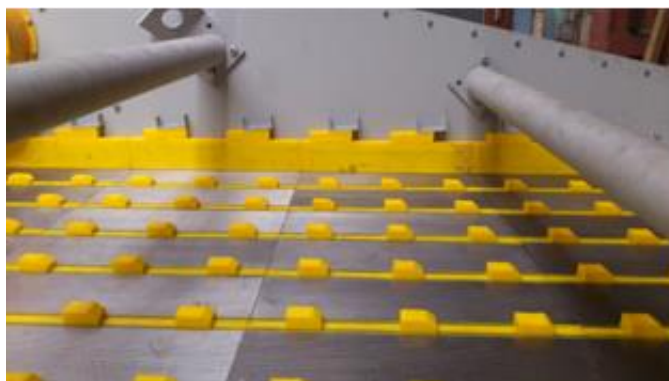
Rys.14. Pokład sit szczelinowych zgrzewanych zabudowanych w systemie PRO-CLIN
