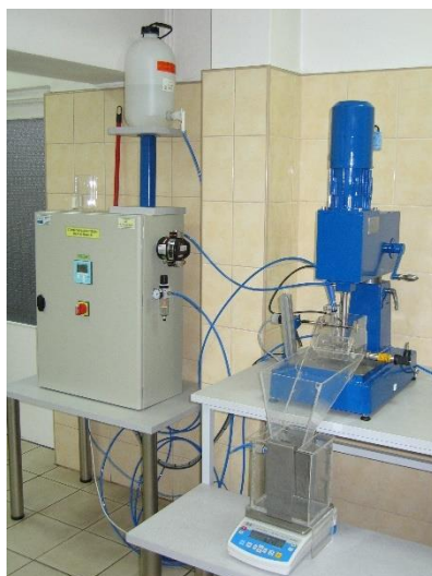
Rys.3. Stanowisko laboratoryjne procesu flotacji [źródło: opracowanie własne]
