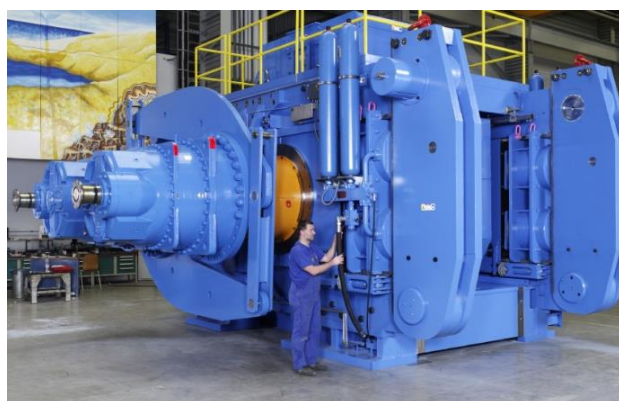
Rys.9. Młyn walcowy firmy Köpern [21] podczas montażu
