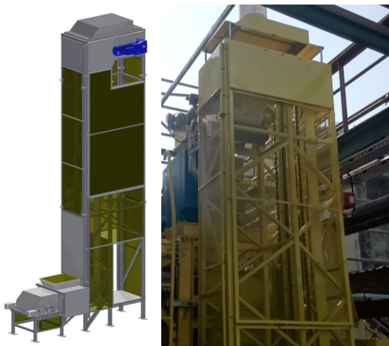
Rys.6. Pionowy transporter próbki PTP [2]
