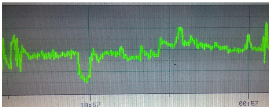
Rys.7. Wydajność wskazywana przez wagę zainstalowaną na przenośniku transportującym nadawę. Zdjęcie fragmentu ekranu sterownika technologicznego. Podziałka główna wykresów 250 t/h [źródło: opracowanie własne]
