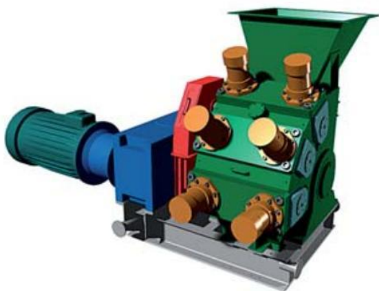
Rys.14. Młyn walcowy PREMILL firmy PSP [5] – wirtualny model
