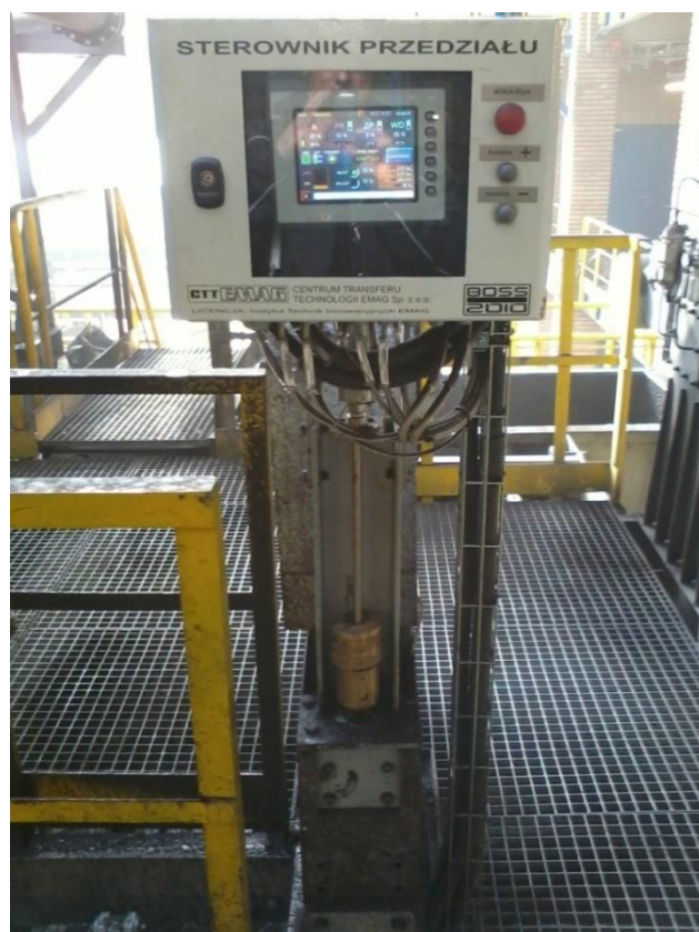
Rys.6. Sterownik przedziału w układzie automatycznego sterowania osadzarką OMD3-4x7,5 (źródło: materiały własne)
