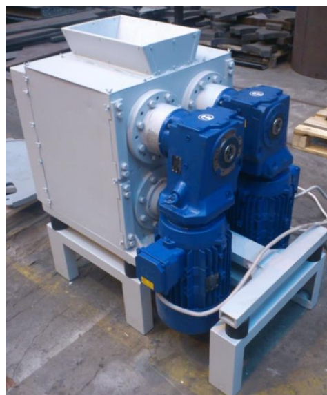
Rys.9. Kruszarka walcowa KW240 [5]
