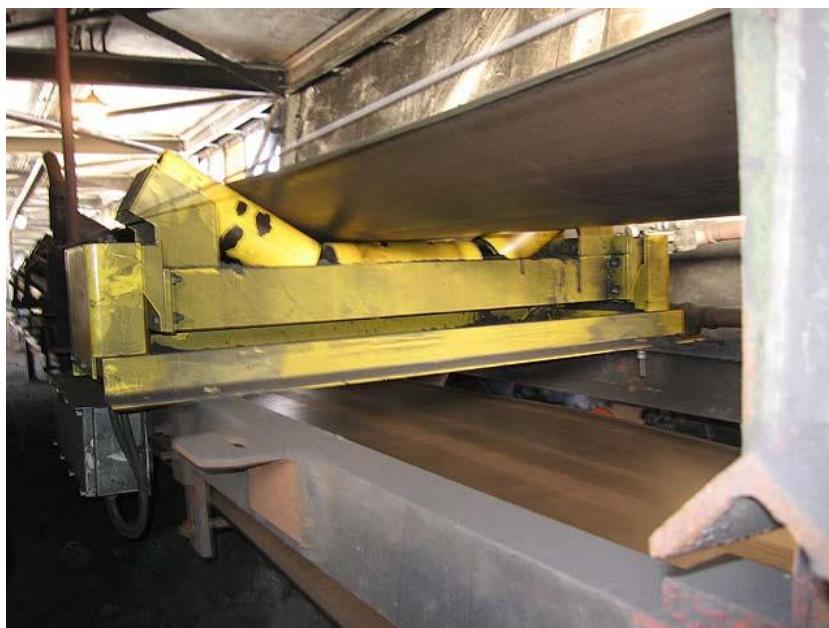
Rys.5. Waga taśmociągowa typu Roll-400 [źródło: opracowanie własne]
