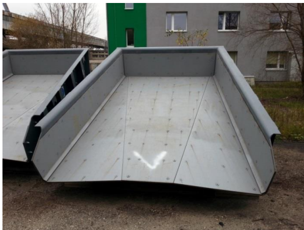
Rys.8. Podajnik trapezowy WPT2,6 [źródło: opracowanie własne]
