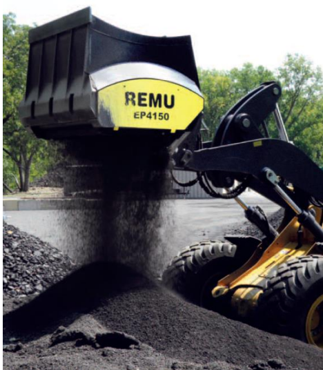
Rys.6. Łyżka krusząco-przesiewająca fińskiej firmy REMU [15]
