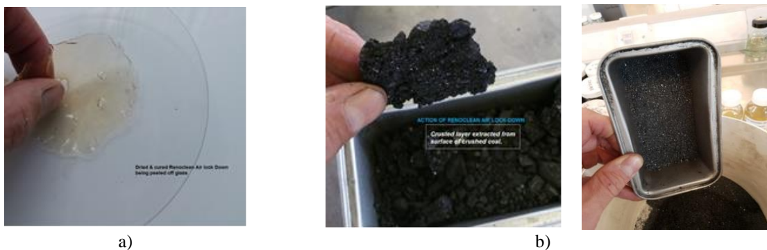
Rys. 3. Przykład środka (RENOCLEAN AIR LOCK-DOWN) po związaniu na płycie laboratoryjnej oraz próbce węgla [10]: a) elastyczna warstwa po odparowaniu wody, b) związane cząstki węgla (pyłu i miału) produktem po odparowaniu wody
