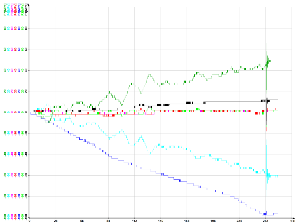
Rys. 6. Jazda kabiny w górę V = 0,3 m/s, Q = 0 kg
