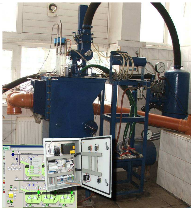
Rys.4. Badania laboratoryjne systemu sterowania osadzarką
