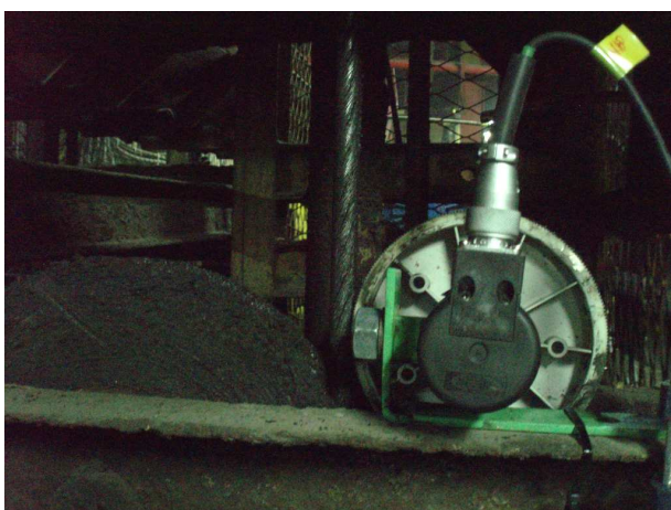
Rys.8. Czujnik do pomiaru przemieszczenia liny napinającej wózek [5]
