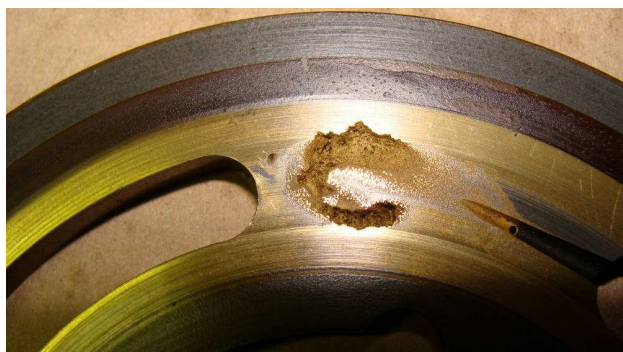
Rys.4. Przykład zużycia kawitacyjnego – mostek rozrządczy na tarczy rozdzielczej pompy wielotłoczkowej
