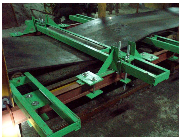
Rys.9. Stanowisko do pomiaru siły w taśmie [5]
