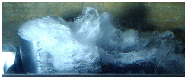
Rys.11. Wiry kawitacyjne za cylindrem zamontowanym na dnie tunelu wodnego przy wysokiej prędkości przepływu zarejestrowane przez zespół badaczy amerykańskich pod kierunkiem prof. Rogera Arendta z Uniwersytetu w Minnesocie, USA. a), b), c), d) rosnąca prędkość przepływu cieczy (wody) w tunelu
