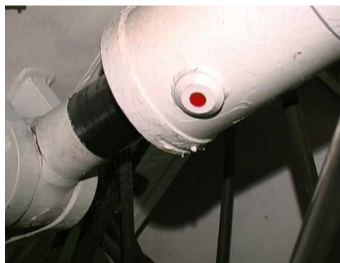
Rys.5. Przykłady montażu transponderów RFID na elementach sekcji
