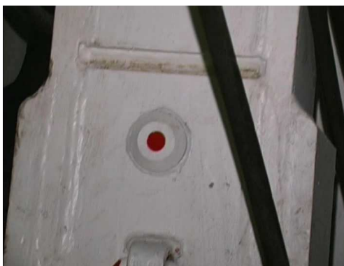
Rys.5. Przykłady montażu transponderów RFID na elementach sekcji
