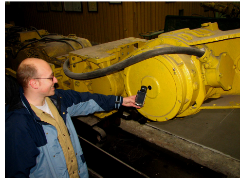
Rys.2 Próby stanowiskowe zastosowania technologii RFID do wyświetlania informacji zawartej w IETM
