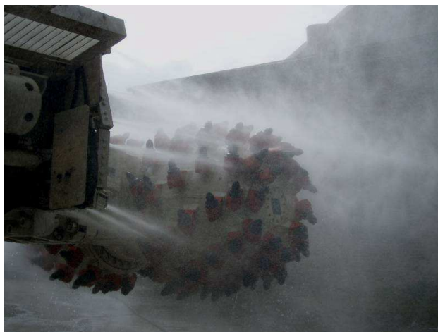
Rys.6. Widok na działającą kurtynę powietrzno-wodną, zabudowaną na kombajnie chodnikowym typu R-200
