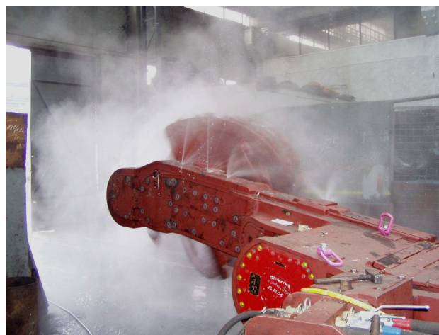
Rys.1. Działająca instalacja powietrzno-wodna kombajnu ścianowego typu KSW-460NE
