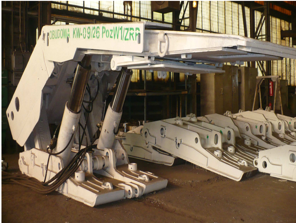
Rys.4. Zmechanizowana obudowa ścianowa KW-09/26 POz W1/ZRP [6]
