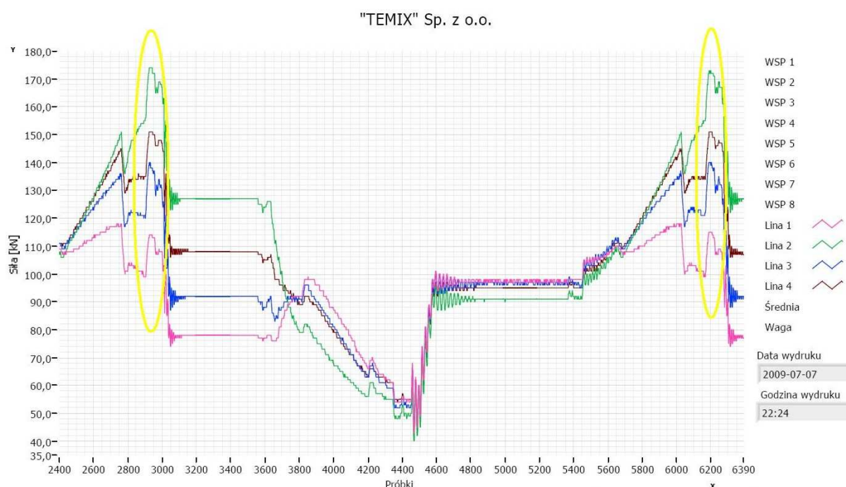
Rys.7. Zarejestrowany rozkład obciążeń w linach czterolinowego wyciągu szybowego z maszyną wyciągową umieszczoną na wieży w czasie dwóch cyklu pracy (próbki od około 3400 do 6390)
