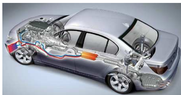
Rys.9. Wizualizacja budowy generatora termoelektrycznego konstrukcji BMW [15]
