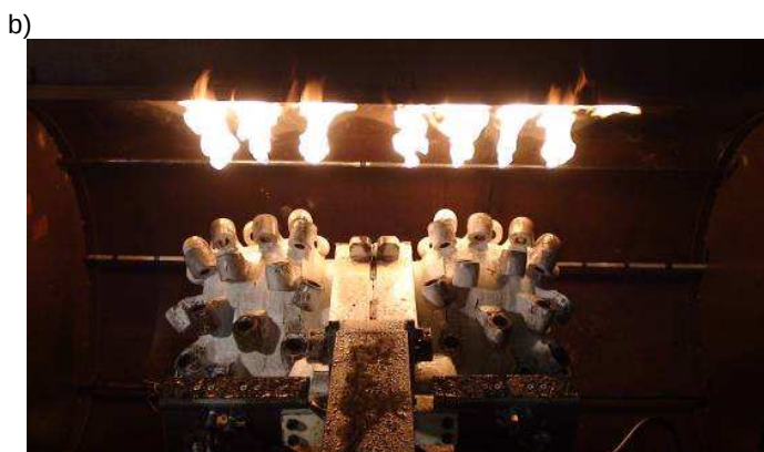
Rys.7. Badania skuteczności gaszenia zapalonego gazu – zapalone palniki górny i dolny przed rozpoczęciem gaszenia: a) kombajn R-200, b) kombajn R-130 [7, 8]
