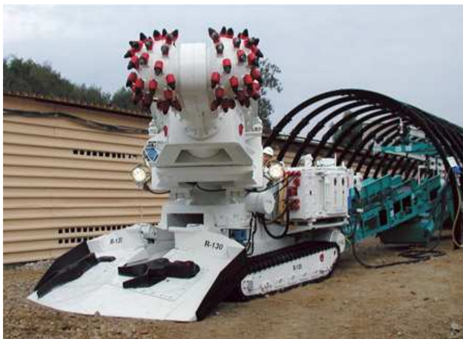
Rys.4. Kombajn chodnikowy R-130 w wersji niskiej produkcji REMAG S.A. [6]
