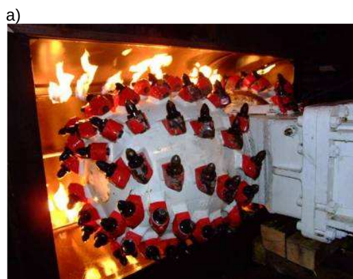
Rys.7. Badania skuteczności gaszenia zapalonego gazu – zapalone palniki górny i dolny przed rozpoczęciem gaszenia: a) kombajn R-200, b) kombajn R-130 [7, 8]
