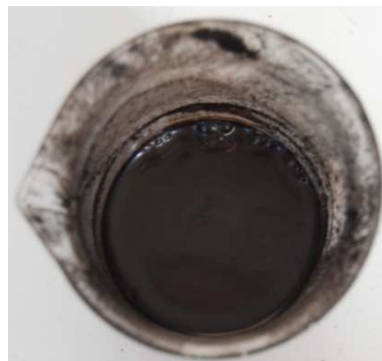
Rys.4. Stan próbki odpadów flotacyjnych pobranych w kopalni produkującej węgiel typu 33
