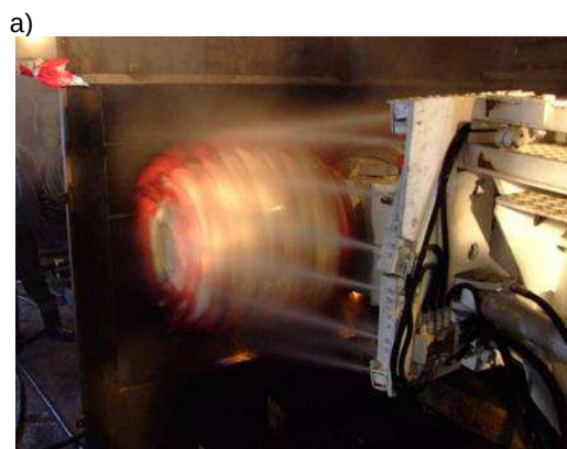
Rys.8. Gaszenie zapalonych płomieni gazu za pomocą powietrzno-wodnej kurtyny zraszającej: a) kombajn R-200, b) kombajn R-130 [7, 8]
