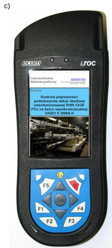
Rys.3. Rozwiązania w zakresie materiałów szkoleniowych: a) materiały oparte na technologii wzmocnionej rzeczywistości, b) interaktywne materiały szkoleniowe, c) elektroniczne instrukcje udostępniane za pośrednictwem RFID
