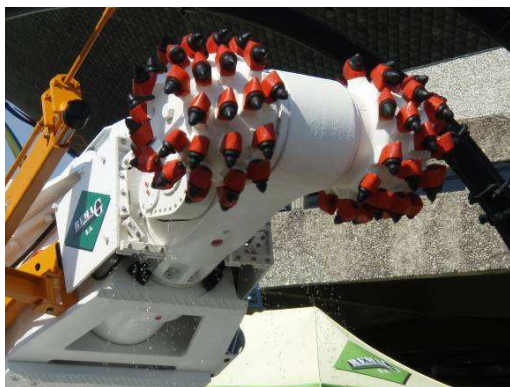
Rys.5. Kurtyna powietrzno-wodna zabudowana na kombajnie R-130
