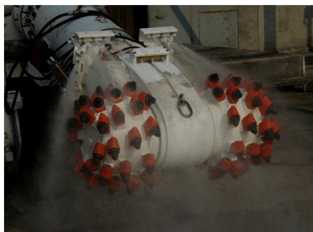
Rys.1. Kurtyna powietrzno-wodna zabudowana na kombajnie R-130 [6]
