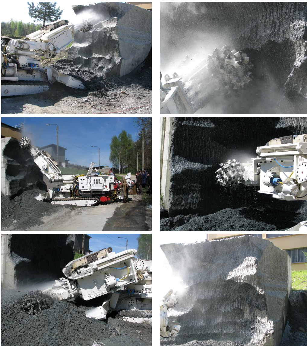
Rys.8. Kombajn chodnikowy R-130 w czasie badań na terenie firmy REMAG S.A.
