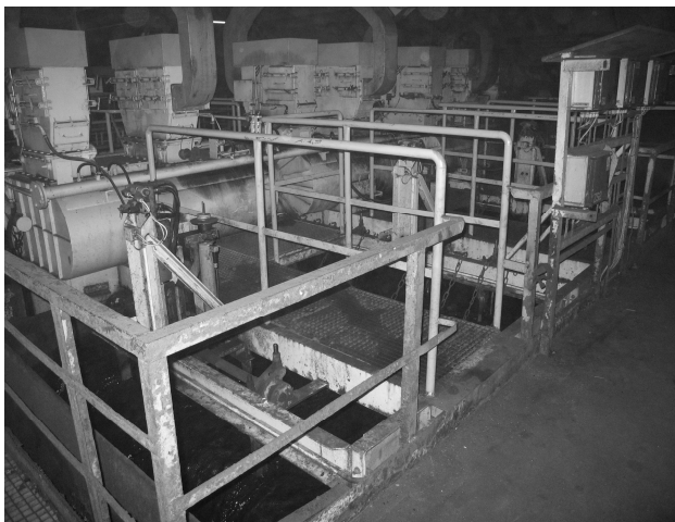
Rys.1. Obiekt badań - osadzarka średnioziarnowa OS 36D3E
