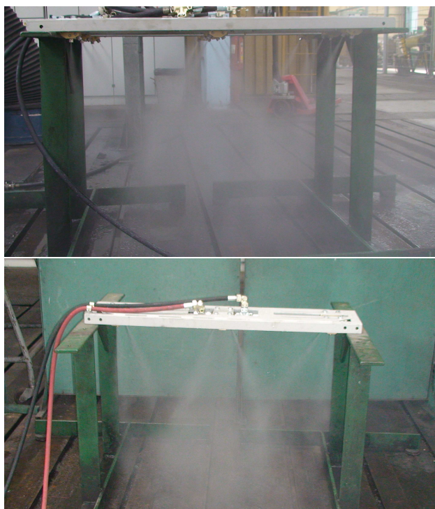
Rys.8. Zraszacz przesypu BRYZA 1200/B podczas prób stanowiskowych [3]
