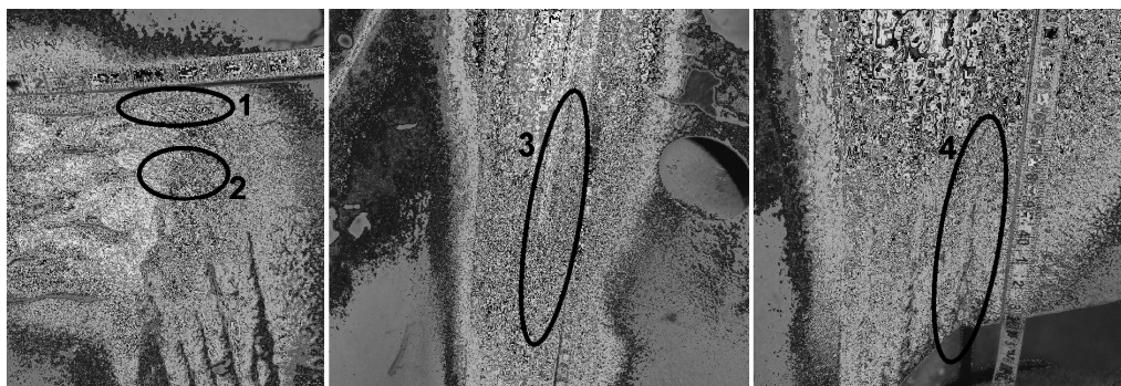
Rys.3. Wskazania z badań magnetyczno–proszkowych dla złącza spawanego S8 [17]
