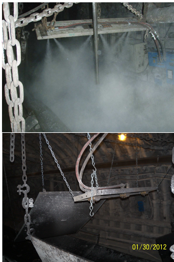
Rys.9. Prototypowe rozwiązanie zraszacza BRYZA 1200/B podczas badań dołowych [6]
