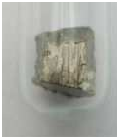
Rys.1. \text{Nd}_2\text{Fe}_{14}\text{B} - związek międzymetaliczny będący podstawowym elementem struktury magnesów neodymowych [1]
