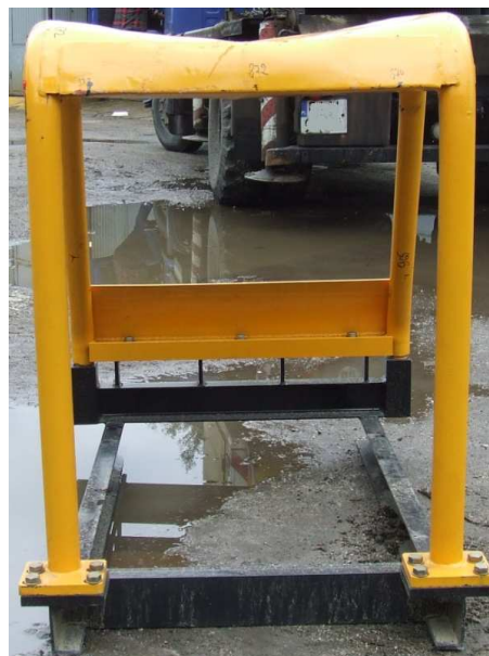
Rys.10. Odkształcenie poszycia górnego konstrukcji ochronnej [1]
