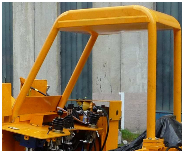
Rys.2. Konstrukcja ochronna operatora (kabina) ładowarki ŁBT-1200M [3]
