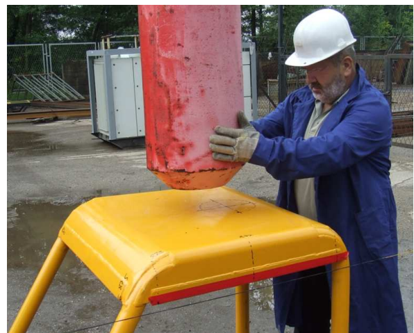
Rys. 7. Wyznaczanie miejsca uderzenia obciążnika [1]
