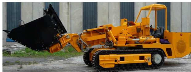
Rys.1. Ładowarka bocznie wysypująca ŁBT-1200M z zabudowaną konstrukcją ochronną operatora [3]
