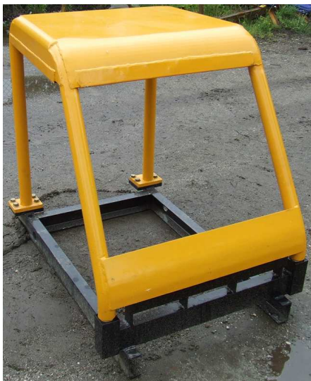
Rys.5. Konstrukcja kabiny operatora przeznaczona do badań niszczących [1]
