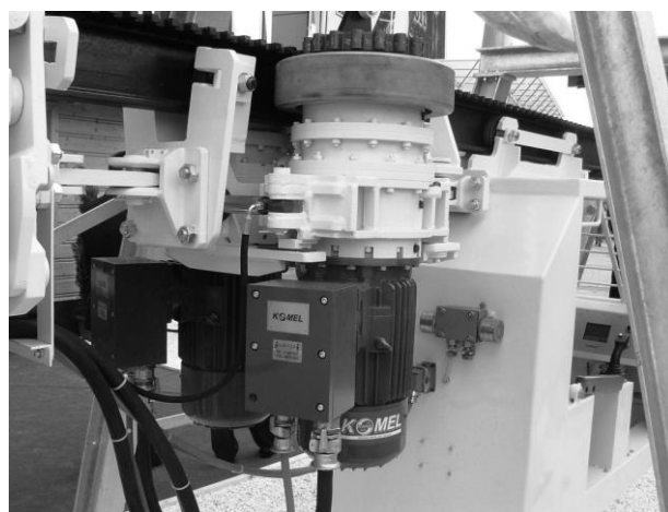
Rys. 5. Zespół napędowy z bezszczotkowymi silnikami synchronicznymi z magnesami trwałymi typu SMwsPA132M61 [6]
