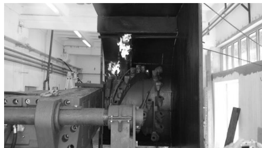
Rys. 11. Próba gaszenia zapłonu gazu [9]
