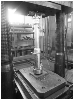
Rys. 13. Stojak SHR-960 podczas badań statycznych i dynamicznych [źródło: opracowanie własne KOMAG]
