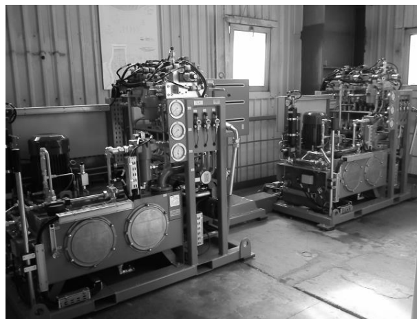
Rys. 3. Elektrohydrauliczny zespół zasilająco-sterujący hamulca H-C MWM-4/VER.III z przełącznicą LP-4 [źródło: własne]
