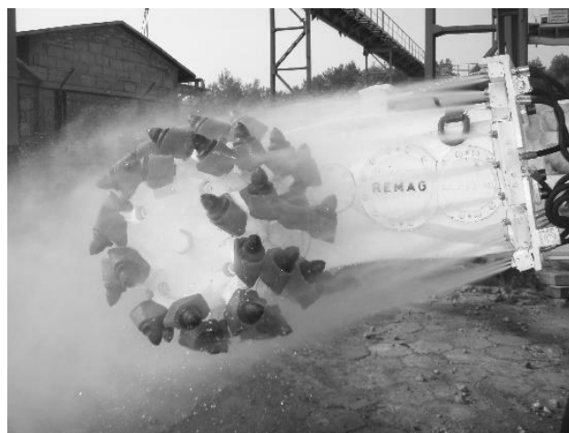
Rys. 6. Kurtyna powietrzno-wodna kombajnu chodnikowego typu R-130 firmy REMAG [16]
