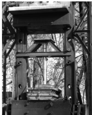
Rys. 13. Stojak SHR-960 podczas badań statycznych i dynamicznych [źródło: opracowanie własne KOMAG]
