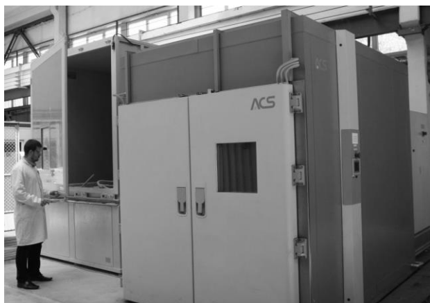
Rys. 11. Komory klimatyczna i pyłowa [źródło: fot. KOMAG]
