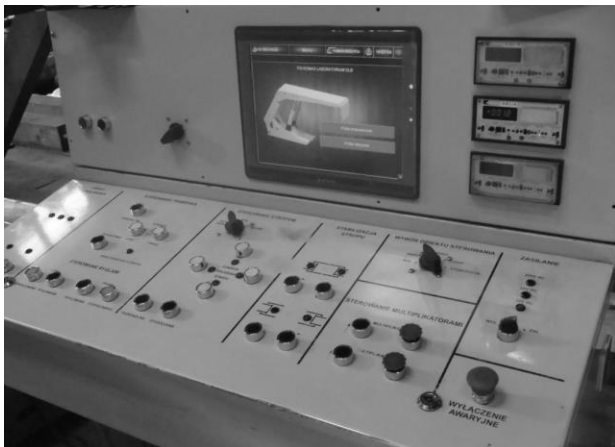
Rys. 5. Pulpit sterowniczy stanowiska do badań funkcjonalności i kinematyki sekcji obudowy zmechanizowanej [2]
