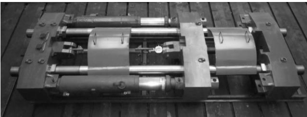
Rys. 3. Stanowisko do badań podpór hydraulicznych [2]
