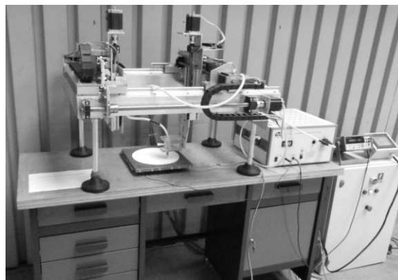
Rys. 13. Skaner potencjału powierzchniowego z unikatowym woltomierzem elektrostatycznym [11]
