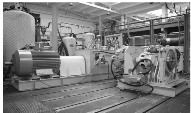
Rys. 10. Stanowisko do badań elementów hydrauliki siłowej [źródło: fot. KOMAG]
