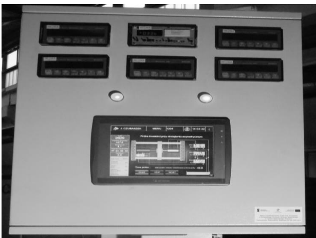
Rys. 6. Pulpit sterowniczy stanowiska do badań podpró hydraulicznych [2]
