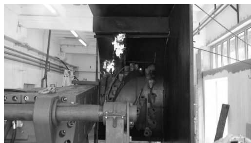
Rys. 11. Próba gaszenia zapłonu gazu [9]
