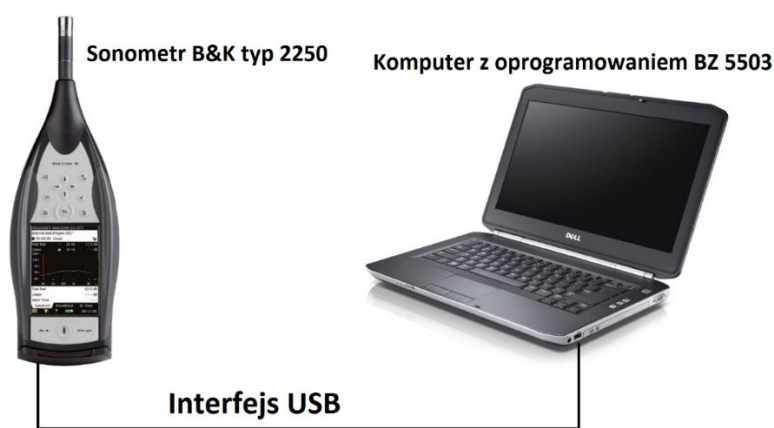
Rys. 7. Schemat toru pomiarowego do pomiaru wielkości akustycznych
