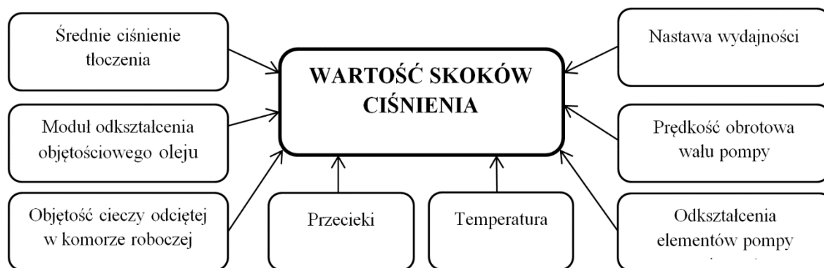
Rys.2. Czynniki wpływające na wartość skoków ciśnienia w pompie PWK [2]
