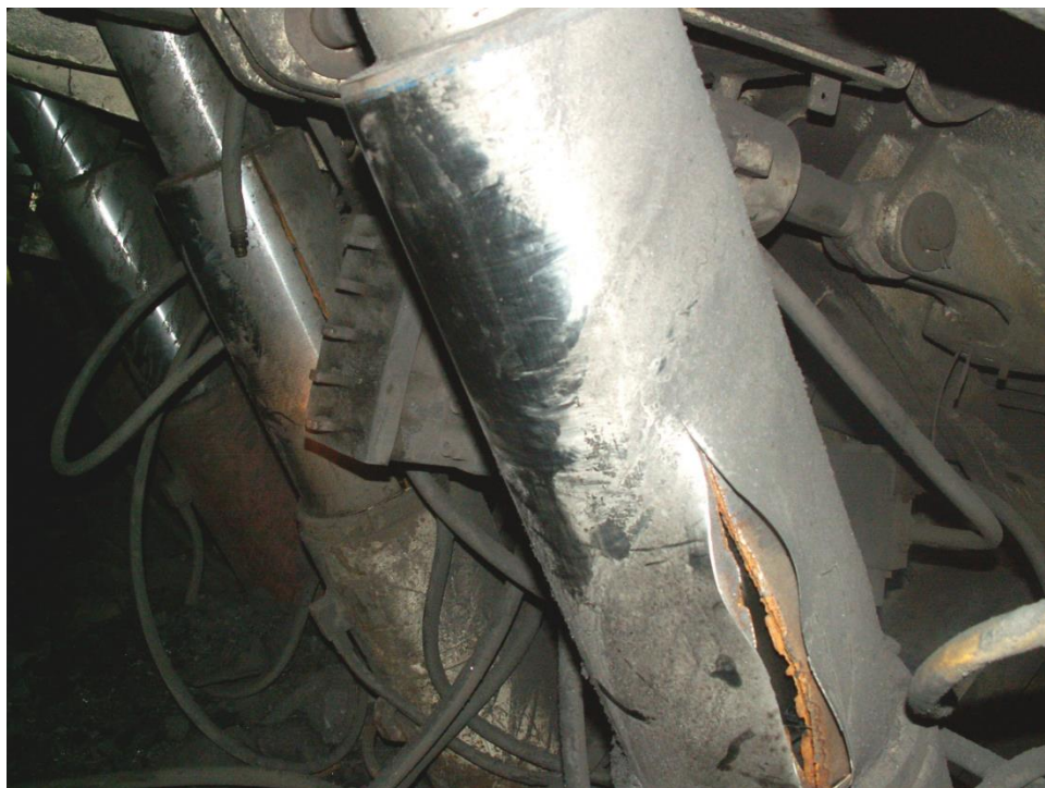
Rys. 3. Rozerwany cylinder II-go stopnia stojaka hydraulicznego \varnothing 0,21/0,16 m [9]
