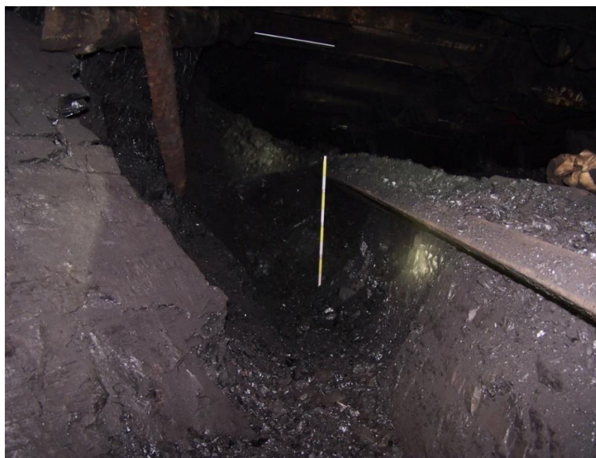
Rys. 2. Trasa przechylonego przenośnika ścianowego po tąpnięciu [9]
