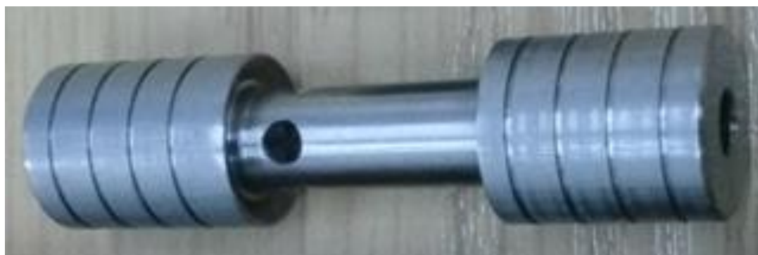
Rys. 21. Suwak główny po badaniach laboratoryjnych. Widoczne „zmatowienie” czopów będące efektem wirowania suwaka i jego docisku siłami hydrodynamicznymi do powierzchni tulei 2
