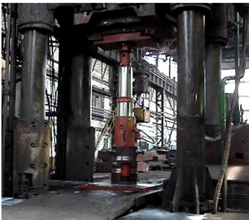
Rys.2. Badania siłowników na prasie hydraulicznej [2]
