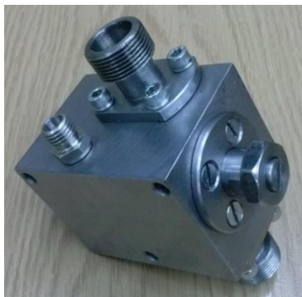
Rys. 5. Widok ogólny prototypu regulatora przepływu bez mechanizmu obrotu tulei 2.
