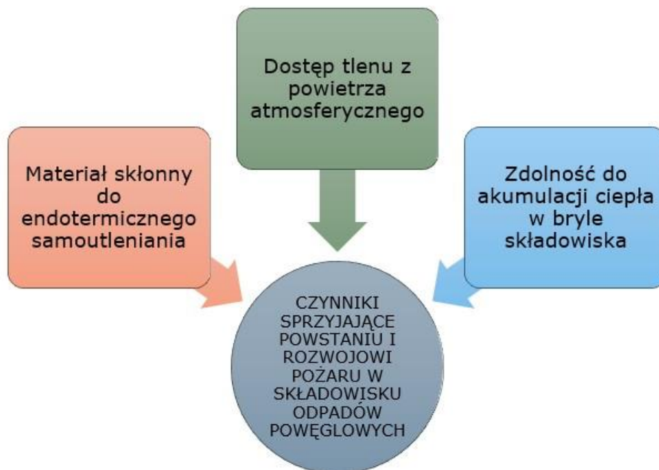
Rys. 1. Czynniki (warunki) rozwoju pożaru w składowisku odpadów powęglowych [opracowanie własne]
