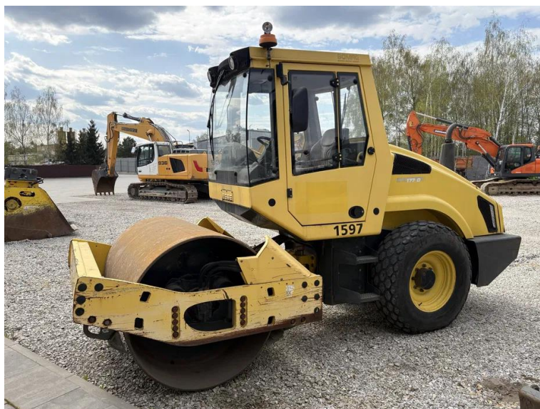
Rys. 4. Przykład walca wibracyjnego do zagęszczania warstwa odpadów [opracowanie własne]
