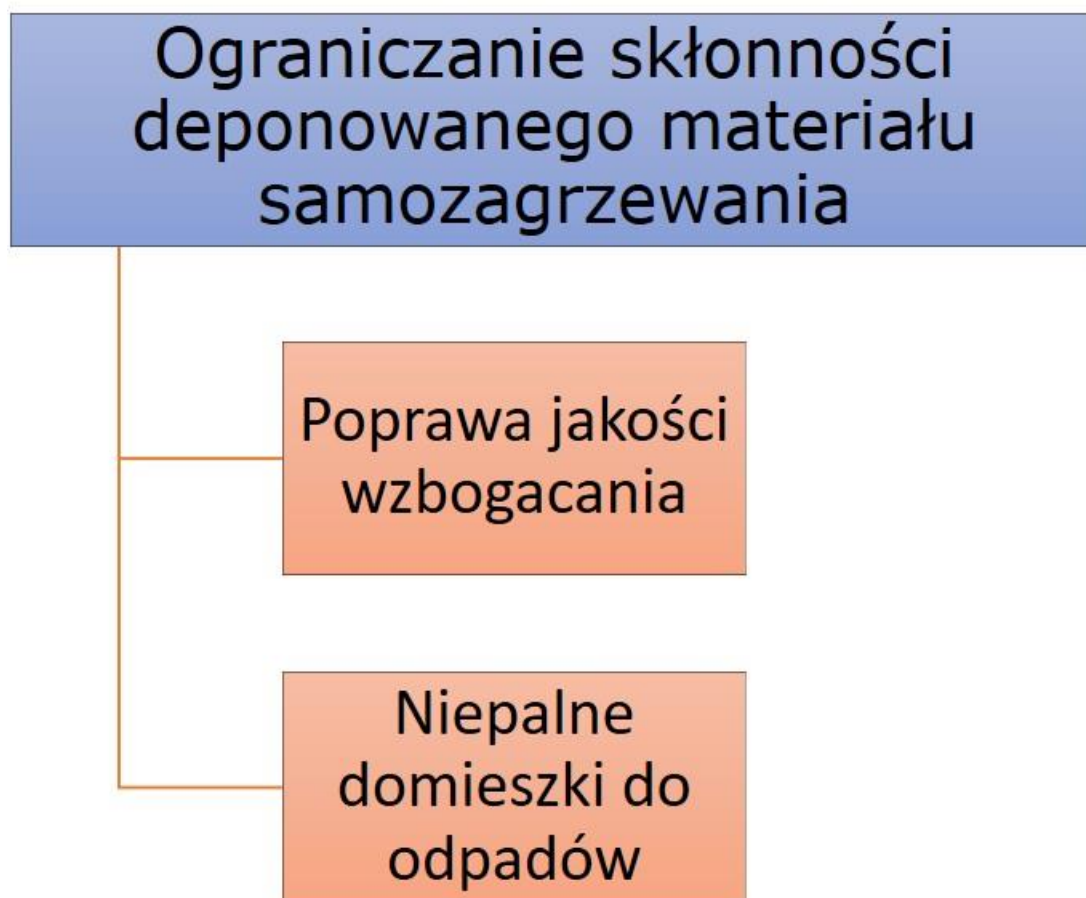
Rys. 3. Ograniczanie skłonności odpadów do samozagrzewania [opracowanie własne]
