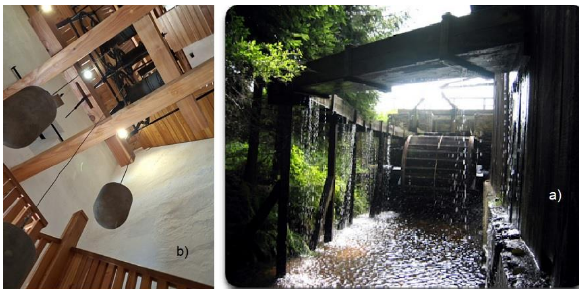
Rys. 1. Historyczne magazyny energii: koło wodne ze stawidłem spiętrzającym wodę (a) i mechanizm zegara wieżowego z obciążnikami (9)
