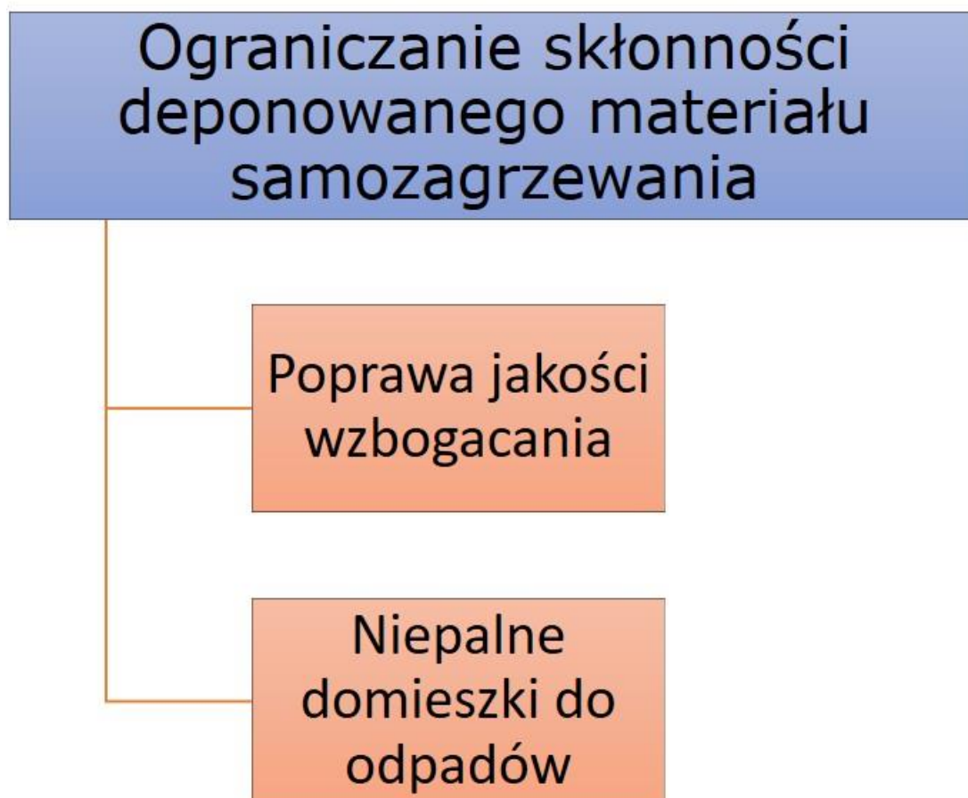
Rys. 3. Ograniczanie skłonności odpadów do samozagrzewania [opracowanie własne]
