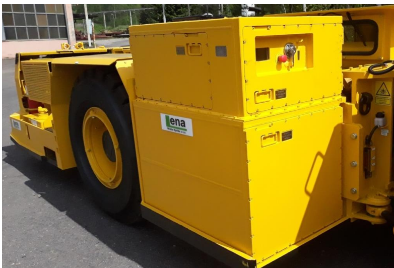
Rys. 7. Zespół zasilania bateryjnego (wykonanie 3) [5]
