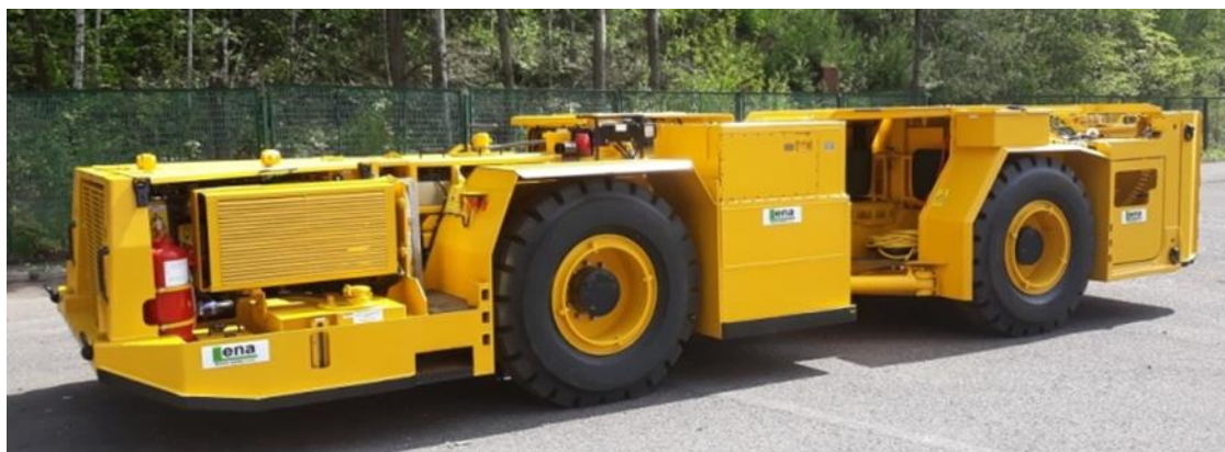
Rys. 9. Wóz strzelniczy SWS-1700ENB produkcji LENA-Wilków [8]
