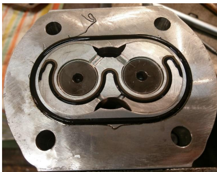
Rys. 15. Pierścień uszczelniający znajdujący się pomiędzy pokrywą i trzecim fragmentem korpusu pompy
