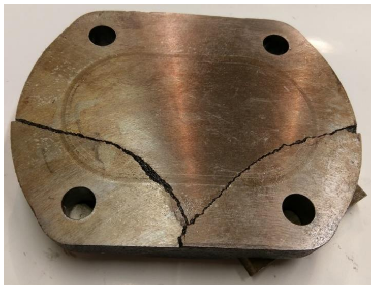
Rys. 12. Uszkodzona pokrywa jednostki nr 2 wykonana z żeliwa ZL 250
