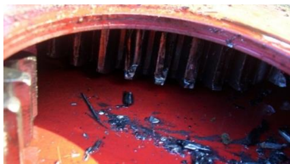
Rys. 6. Uszkodzone koło napędu noży kosiarki dyskowej [źródło: opracowanie własne]
