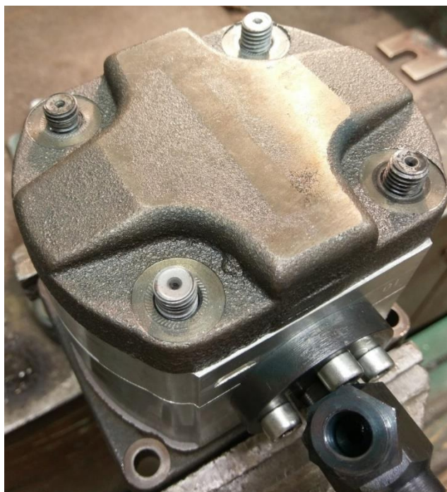
Rys. 9. Uszkodzona Jednostka nr 2. Na zdjęciu widoczne śruby z uszkodzonym gwintem
