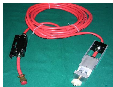
Rys.2. Jednostka główna (z lewej) oraz jednostka zewnętrzna (z prawej) specjalnej aparatury do pomiaru metodą dynamiczną [11] naprężeń zmiennych doznawanych przez cięgła nośne skipu podczas jego jazdy w szybie [źródło: opracowanie własne]
