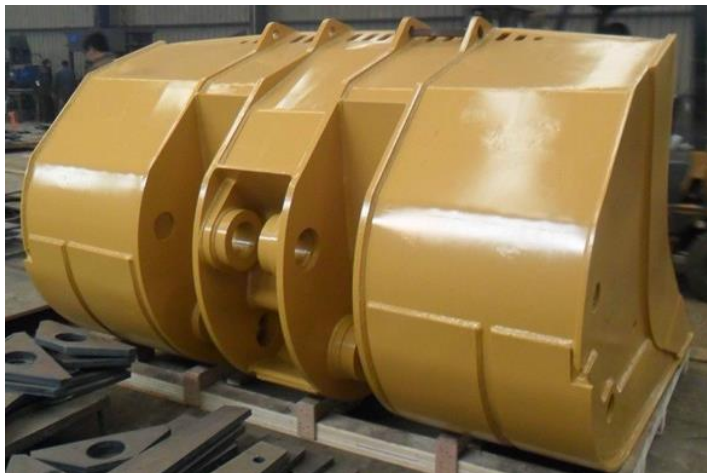
Rys. 7. Czerpak firmy Caterpillar z wewnętrznym mocowaniem [6]
