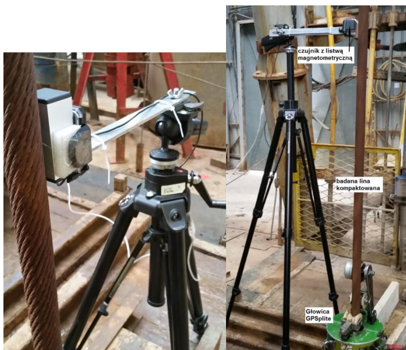
Rys.7. Usytuowanie głowicy GPSplit oraz listwy z magnetometrami na badanej linii w trakcie badań porównawczych
