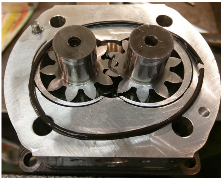
Rys. 14. Uszkodzony pierścień uszczelniający znajdujący się pomiędzy pierwszym, a drugim elementem korpusu pompy
