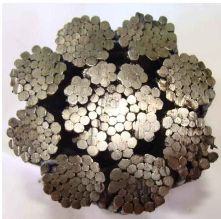
Rys. 4. Lina 60 8x36WS-IWRC 1770 A [fot. ZRUT "AUTORYTET"]
