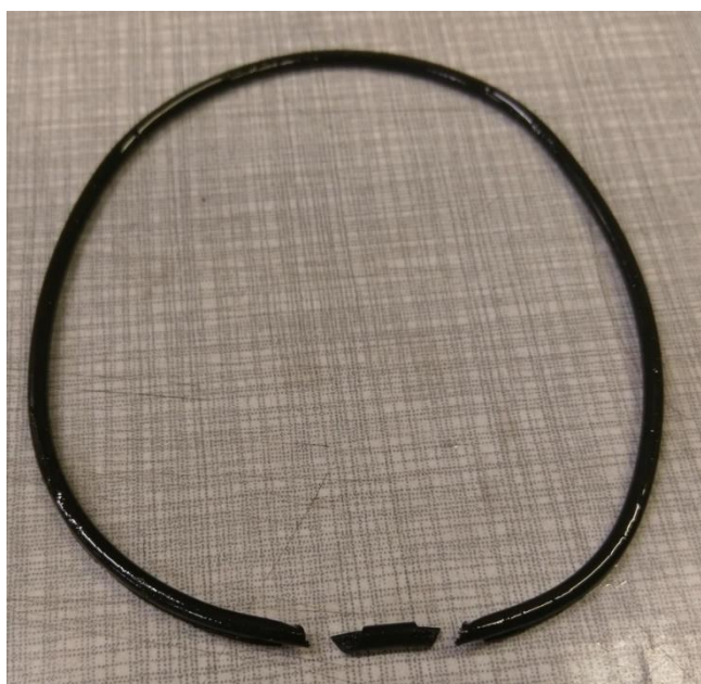
Rys. 8. Uszkodzony pierścień uszczelniający o przekroju kołowym znajdujący się pomiędzy korpusem a pokrywą
