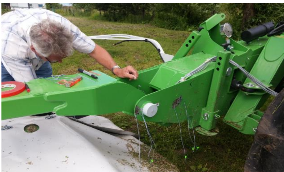
Rys. 3. Rozmieszczenie tensometrów na korpusie kosiarki [źródło: opracowanie własne]
