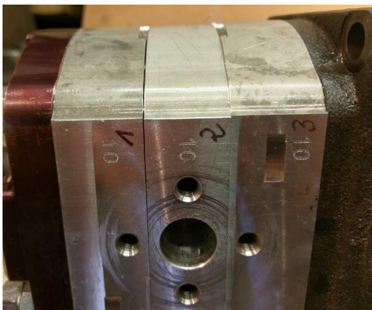
Rys. 13. Jednostka nr 2 po próbie niszczącej z pokrywą wykonaną z żeliwa sferoidalnego EN-GJS-500-7
