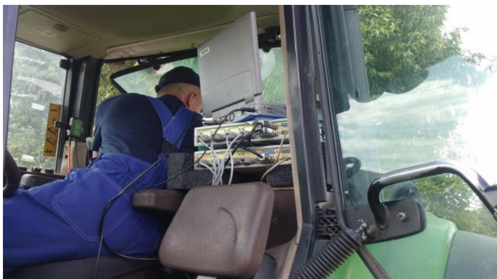
Rys. 1. Stanowisko pomiarowe zlokalizowane w kabinie operatora kosiarki dyskowej [źródło: opracowanie własne]
