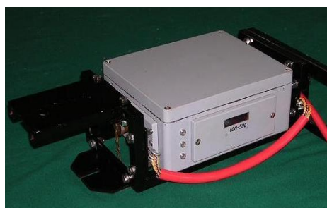
Rys.2. Jednostka główna (z lewej) oraz jednostka zewnętrzna (z prawej) specjalnej aparatury do pomiaru metodą dynamiczną [11] naprężeń zmiennych doznawanych przez cięgła nośne skipu podczas jego jazdy w szybie [źródło: opracowanie własne]
