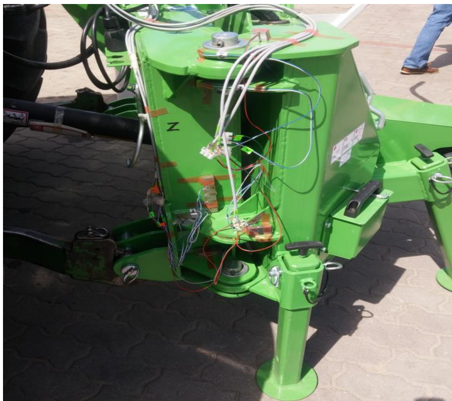
Rys. 2. Rozmieszczenie tensometrów na zaczepie kosiarki [źródło: opracowanie własne]
