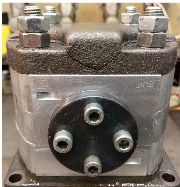
Rys. 11. Strona wewnętrzna uszkodzonej pokrywy
