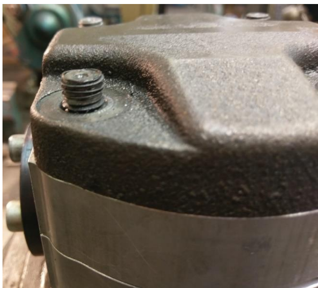
Rys. 10. Uszkodzone śruby mocujące elementy pompy
