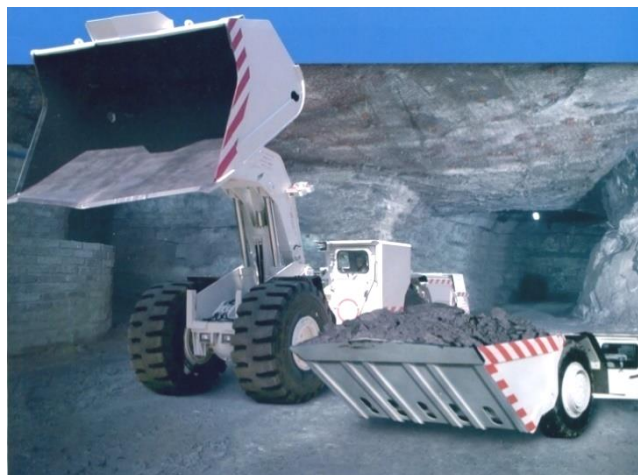
Rys. 10. Widok ładowarek firmy KGHM ZANAM: po lewej typ LKP 0903 o pojemności łyżki 4,5 \text{ m}^3 i po prawej LKP 0301 o pojemności łyżki 1,6 \text{ m}^3 [4, 7]
