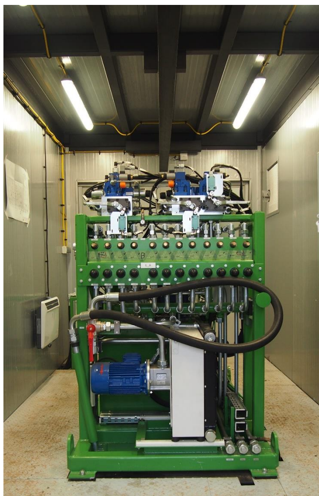
Rys. 5. Moduł elektrohydraulicznego zespołu sterowniczo-zasilającego H-C MWM-4/VER.IIID
