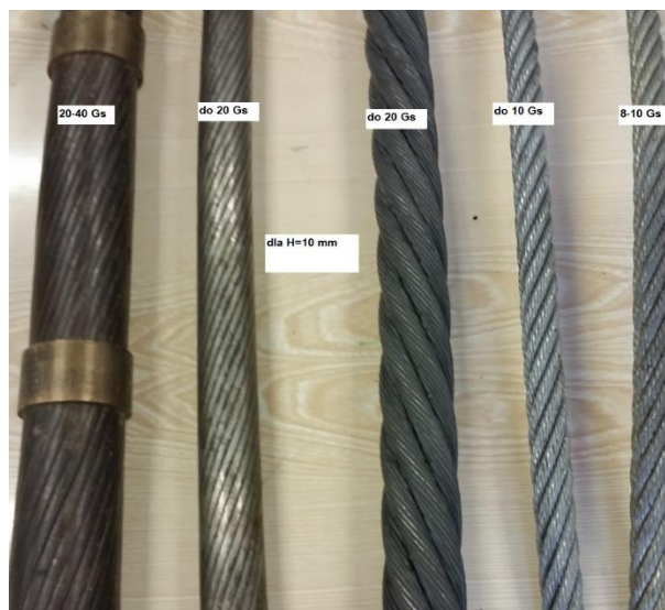
Rys.5. Wartości zmierzonej indukcji w odległości 10 mm nad linami o różnej konstrukcji
