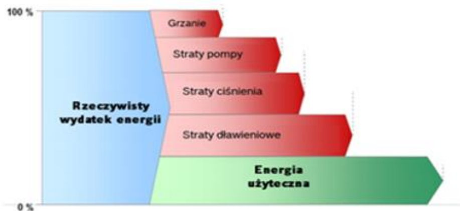
Rys. 2. Straty energii w regulacji dławieniowej [1]
