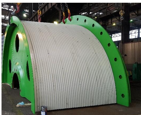
Rys. 8. Połówka bębna nawojowego z wykładziną spiralną [źródło: opracowanie własne]
