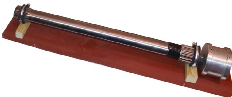
Rys. 7. Momentomierz Mt4000 z układem rejestrującym (źródło: opracowanie własne)
