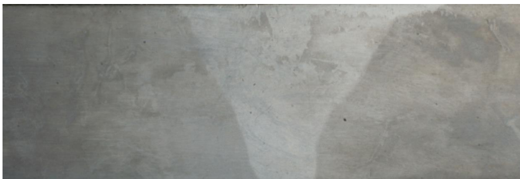
Rys. 8. Makrostruktura złącza spawanego stali Boron 27 z widoczną spoiną i strefą wpływu ciepła (źródło: opracowanie własne)
