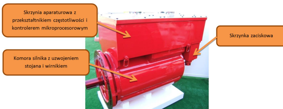
Rys. 1. Rozmieszczenie poszczególnych elementów w silniku zintegrowanym [źródło: opracowanie własne]
