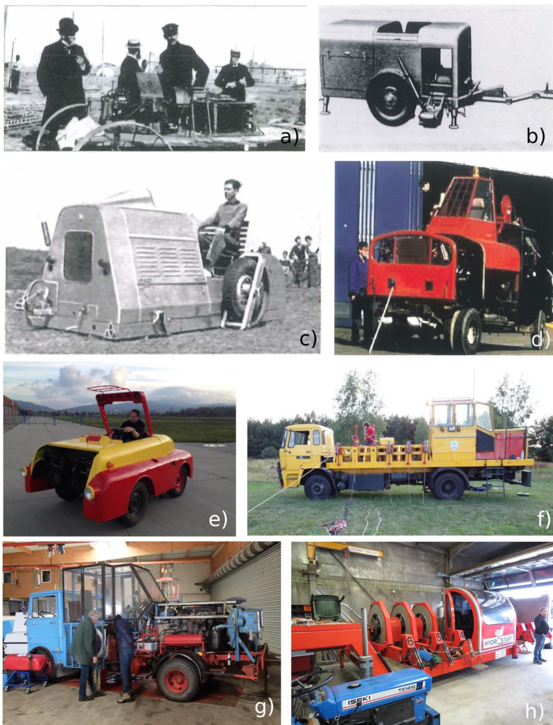
Rys. 5. Rozwój wyciągarek szybowcowych: a) wyciągarka elektryczna Octave Chanut – 1904, USA [9]; b) wyciągarka poprzeczna „Rhön” – 1939, Niemcy [9]; c) wyciągarka wzdłużna „Röder” – 1939, Niemcy [9]; d) wyciągarka 2-bębnowa Hans Tost – 1952, Niemcy [9]; e) wyciągarka samojezdna „Herkules III” – 1955, CSRS [11]; f) wyciągarka 6-bębnowa „Busio van Gelder” – lata 60., Holandia [12]; g) wyciągarka z silnikiem Diesla „Egger” – 1981, Niemcy; h) wyciągarka hydrostatyczna „HydroStart” – 2004, Holandia
