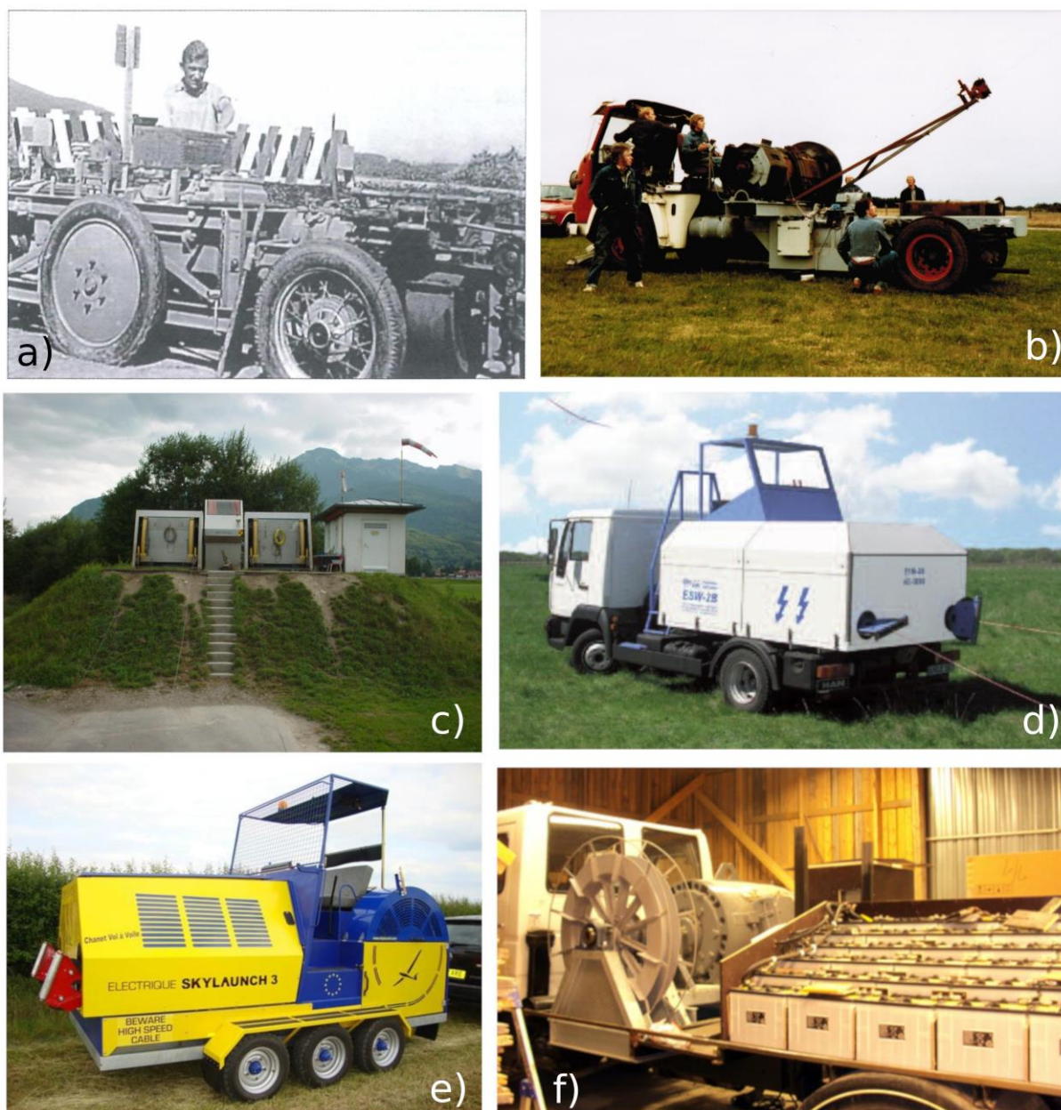
Rys. 6. Elektryczne wyciągarki szybowcowe: a) wyciągarka tramwajowa Otto Schurter – 1940, Szwajcaria [9]; b) wyciągarka hybrydowa „Elvira” – 1983, Dania [16]; c) wyciągarka stacjonarna Unterwössen – 1995, Niemcy [17]; d) wyciągarka akumulatorowa „ESW-2B” – 2001, Niemcy [18]; e) wyciągarka akumulatorowa „Skylaunch 3 Electric” – 2005, Anglia [19]; f) wyciągarka akumulatorowa Lopen Liito-Veto – 2012, Finlandia [20]
