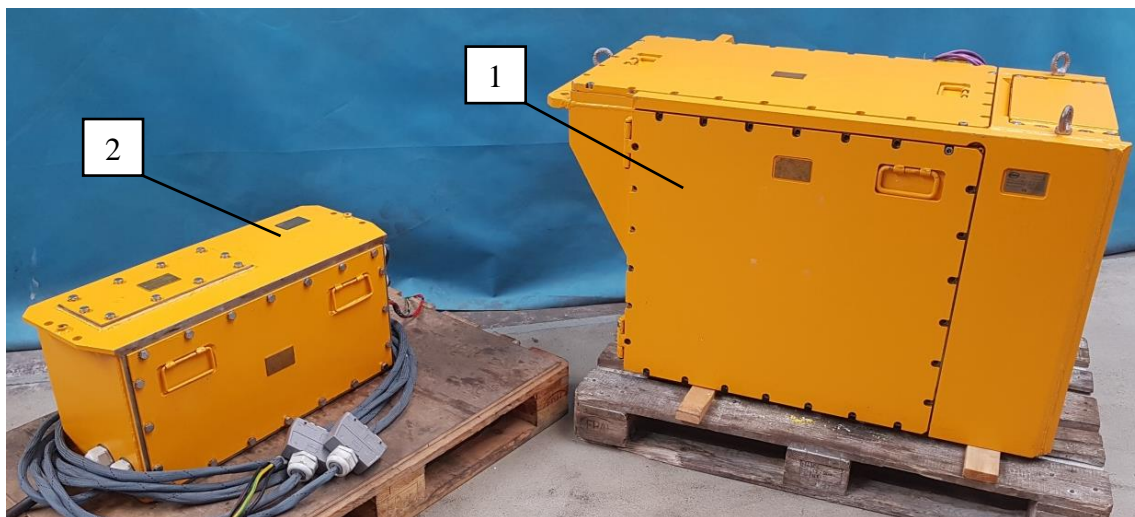
Rys. 3. Nowe rozwiązanie akumulatorowego układu zasilania 1) zespół baterii ZB-2, 2) zespół aparatury ZA-2
