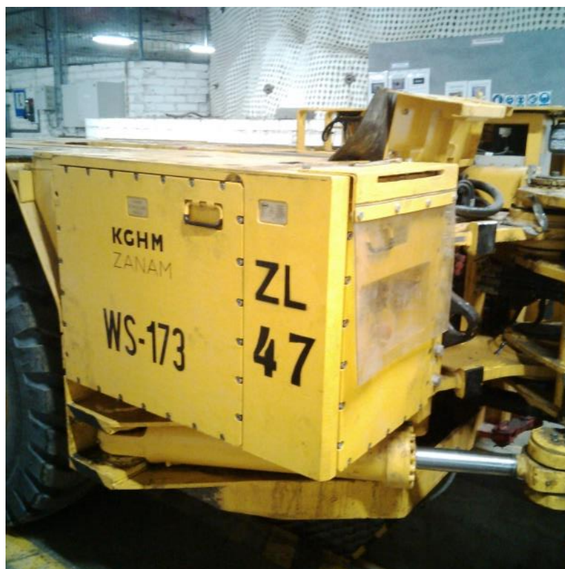
Rys. 7. Wóz strzelniczy z nowym rozwiązaniem akumulatorowego układu zasilającego w kopalni rudy miedzi
