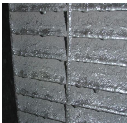
Rys. 5. Zjawisko wychwytywania karty zwilżonego pyłu przez żaluzjowe [10]
