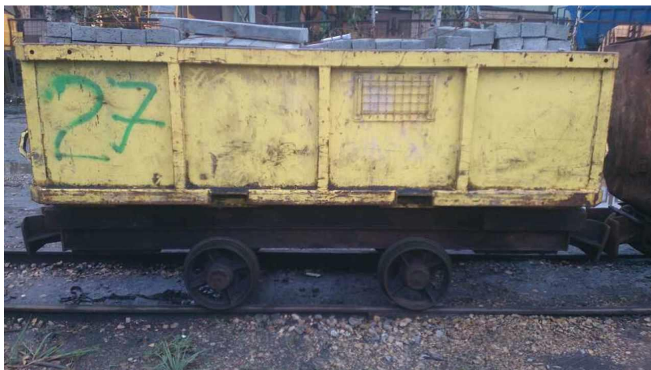
Rys. 2. Zasobnik kontenerowy (źródło: zdjęcie własne, KWK „Murcki-Staszic”)
