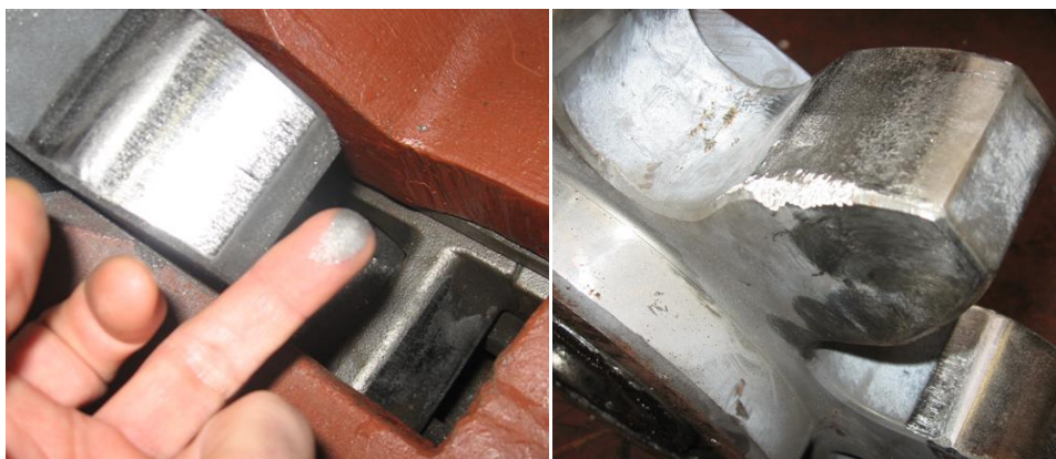
Rys. 18. Widok zużycia kół trakowych współpracujących z elementami zębatego Flextrack (po lewej) oraz drabinką Eicotrack (po prawej) [6]
