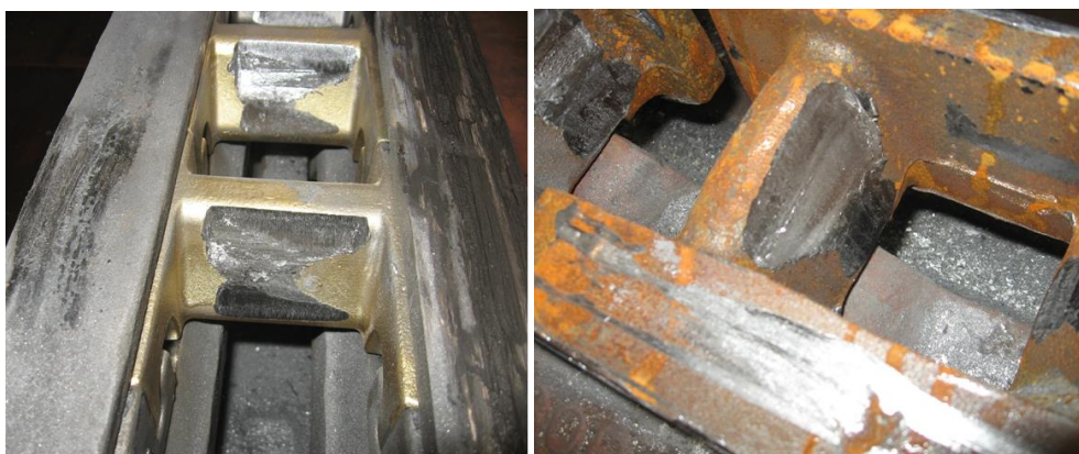
Rys. 17. Widok zużycia elementów zębatki Flextrack (po lewej) oraz drabinki Eicotrack (po prawej) [6]
