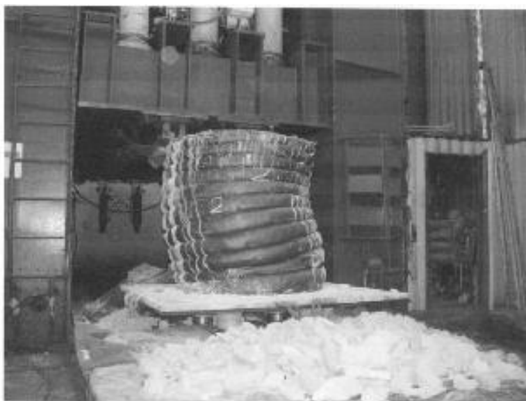
Rys.5. Słup podszkockowy z worka kontenerowego wzmocnionego drutem stalowym w trakcie badań stanowiskowych w NIOSH [źródło - 15]
