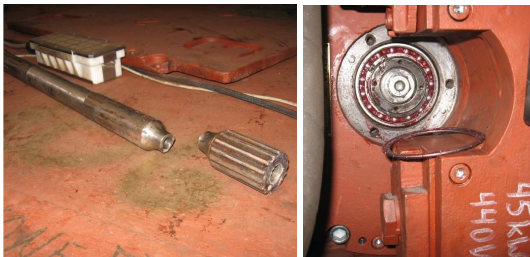
Rys. 9. Problemy zauważone podczas badania systemu Eicotrack – trzykrotne zerwanie przeciążeniowego bezpiecznika mechanicznego i awaria łożyska tocznego [6]
