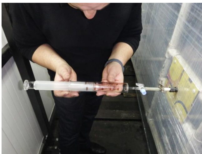
Rys. 7. Pobór próbki zanieczyszczonego powietrza do analizy chromatograficznej [1]
