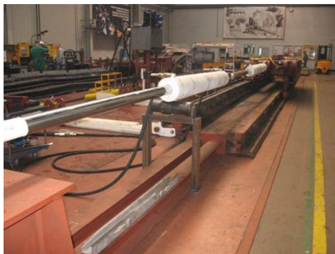
Rys. 3. Widok stanowiska badawczego do badania systemów posuwu kombajnów ścianowych gotowego do badań [6]
