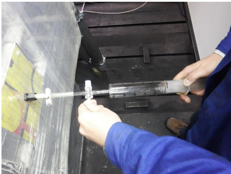
Rys. 5. Wprowadzanie siarkowodoru do komory badawczej [1]
