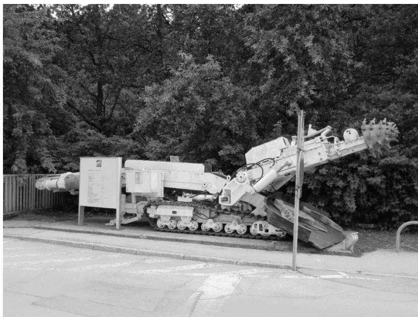
Rys. 2. Kombajn chodnikowy typu PK-7-typowy przedstawiciel lekkich kombajnów chodnikowych do drążenia chodników węglowych
