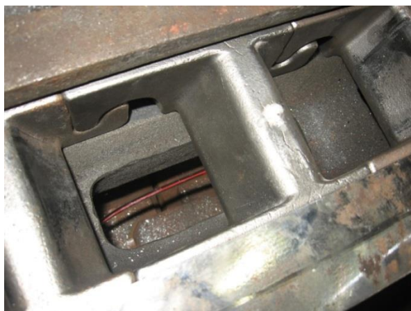
Rys. 13. Widok jednego z segmentów zębatego systemu Flextrack, z wklejonym czujnikiem światłowodowym z siatką Bragg'a do pomiaru wartości odkształceń [6]
