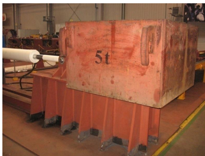
Rys. 6. Widok obciążnika o masie 5 ton stabilizującego ramę do mocowania pary siłowników o wydłużonym skoku [6]
