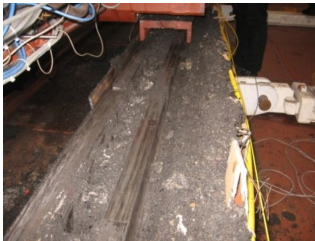
Rys. 15. Widok elementów systemu posuwu Flextrack zasypanych drobnym węglem oraz skałą płonną po jednym przejeździe koła trakowego [6]
