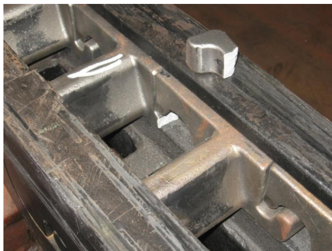
Rys. 5. Widok uszkodzonego segmentu zębatego systemu posuwu Flextrack [6]
