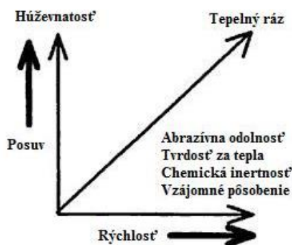
Obr. 7.1 Vplyv vlastností materiálu nástroja na optimalizáciu rezných podmienok
