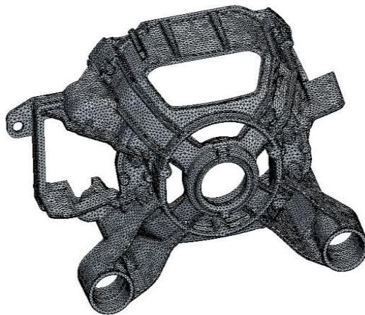
Obr. 70 Ukážka sieťovania geometrie analyzovanej konštrukcie [30]
