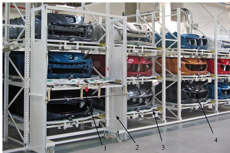
Obr. 10 Regálový systém pre uskladnenie predných masiek automobilu od firmy BESTO (Besto 2013)
