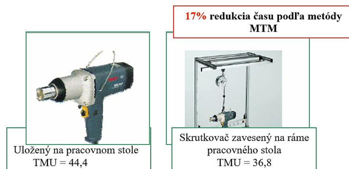
Obr. 11 Redukcia času pri zavesení skrutkovača na rám pracovného stola podľa (Rexroth 2002)
