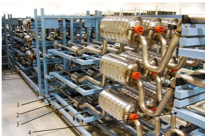
Obr. 11 Regálový systém pre uskladnenie výfukov automobilu vo firme Hyundai (Pecák 2012)
