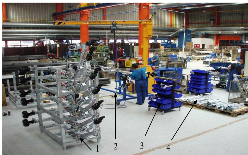
Obr. 9 Regálové systémy pre montáž náprav prívesných vozíkov automobilu vo firme KNOTT (Knott 2013)
