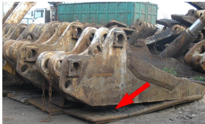
Rys. 6.20. Rozerwana i odkształcona spąglica [105]
