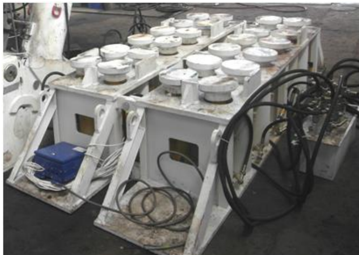
Rys. 5.39. Poduszka hydrauliczna wykorzystywana podczas badań laboratoryjnych umożliwiającą symulację współpracy sekcji ze spągami [40]
