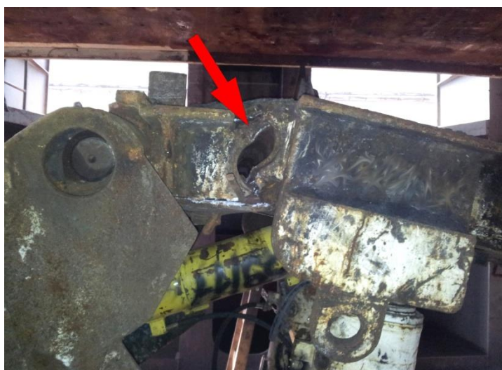
Rys. 6.21. Stropnica sekcji, zdeformowana podczas badań w laboratorium [105]
