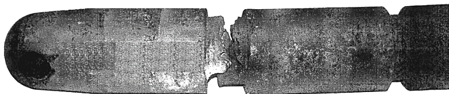
Rys. 6.22. Złamany przedłużacz mechaniczny stojaka [105]
