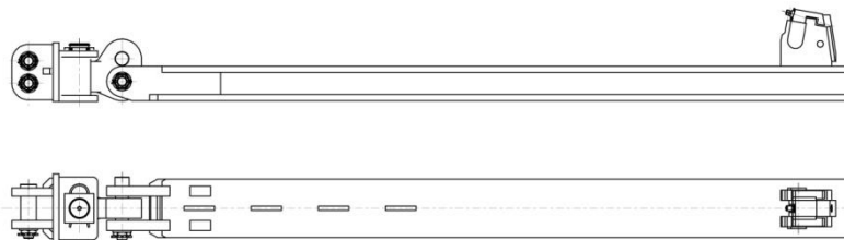
Rys. 6.14. Łącznik układu przesuwne służący do połączenia belki z rynną przerośnika ścianowego za pomocą poziomych sworzni [104]
