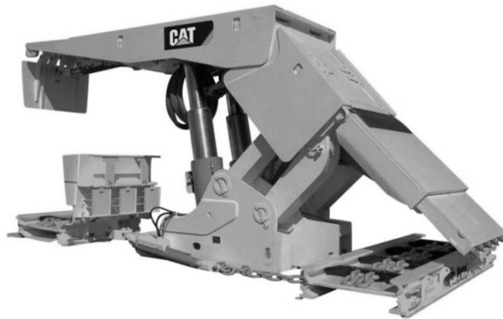
Rys. 3.6 Sekcja ścianowej obudowy zmechanizowanej stosowana w systemie TLCC [134]
