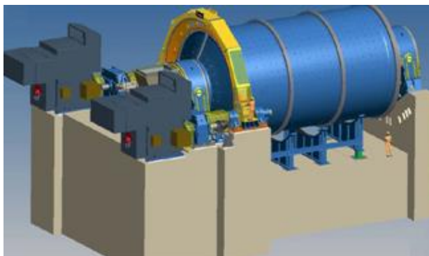
Rys. 6.7. Młyn kulowy z podwójnym napędem obwodowym – dwoma silnikami wolnoobrotowymi do mielenia rud [31]
