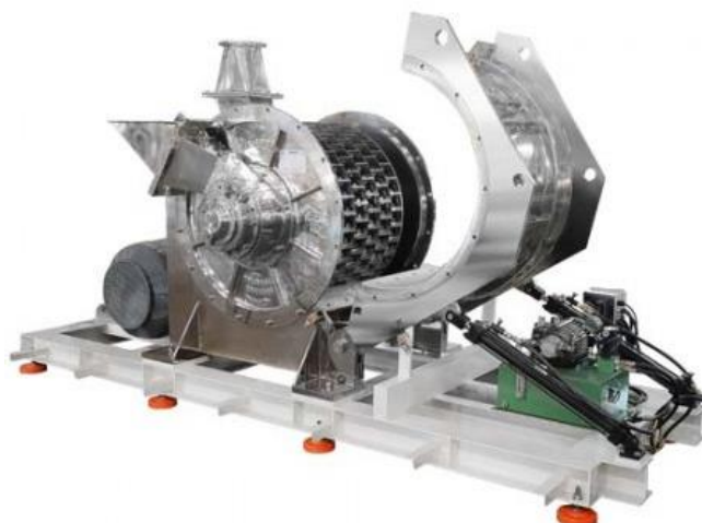
Rys. 12.16. Młyn bijakowy firmy Mill Powder Tech z poziomym wirnikiem turbinowym [19]
