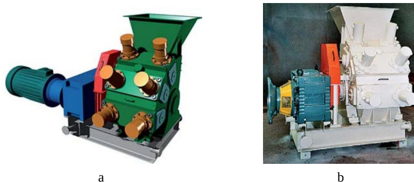
Rys. 11.13. Przykłady budowy młyna walcowego PREMILL firmy PSP [21]: a - model, b - widok młyna
