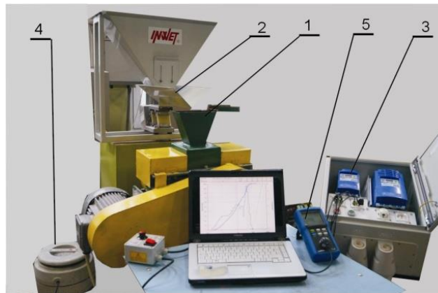
Rys. 5.7. Stanowisko badawcze kruszarki szczękowej: 1 – kruszarka KW-40/1, 2 – dozownik ze zbiornikiem nadawcy, 3 – zasilacz (falownik), 4 – układ odpylania i oczyszczania powietrza, 5 – układ pomiaru i rejestracji mocy (Foto M. Mazur)
