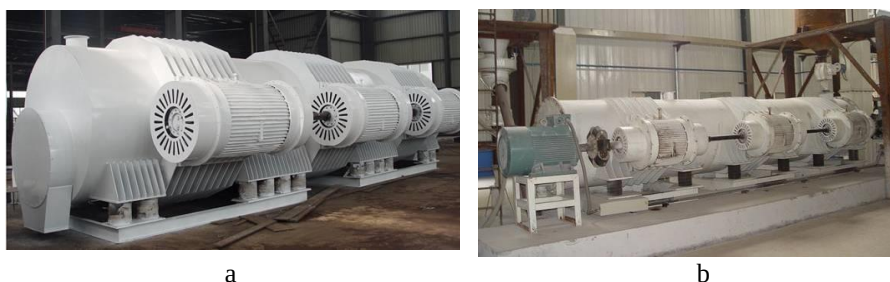
Rys. 8.13. Młyny wibracyjne firmy Lyvenus z trójmodułowym wibratorem: a - widok młyna od strony wylotu zmielonego materiału, b - widok młyna MZD1200X8000 od strony napędu [47]
