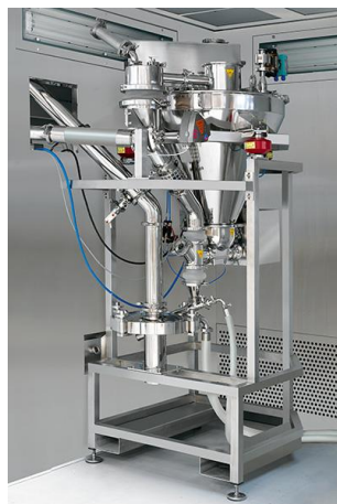
Rys. 14.8. Układy mielenia młyna strumieniowo-spiralnego [15]: a - MCJet Mill 200, b - MC Dec 400
