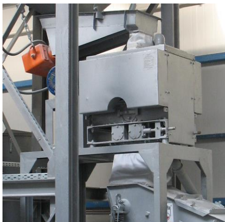
Rys. 5.8. Wibracyjna kruszarka VB-C-30x8 do rozdrabniania przemysłowych odpadów ceramicznych w linii kruszenia [8] (Foto J. Sidor)
