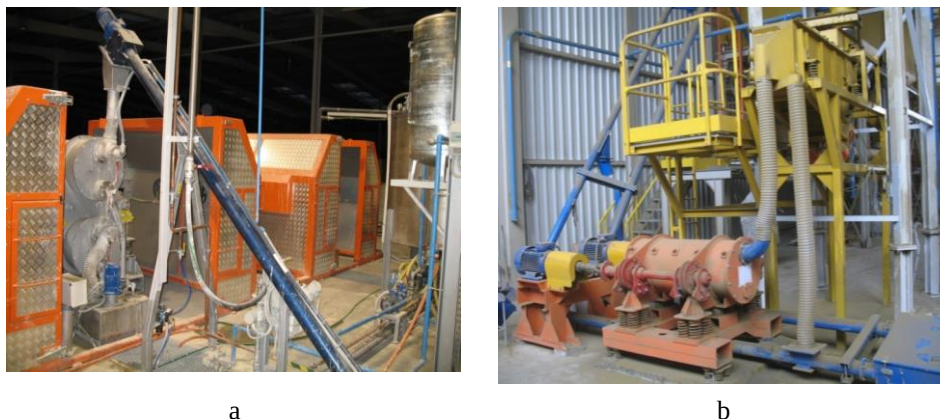
Rys. 8.15. Prototypowe młyny wibracyjne w liniach technologicznych: a – dwukomorowe VM-C-175x2 do mielenia mas ceramicznych zastosowane w 2008 roku, b – jednokomorowy VM-D-200 do mielenia związku chemicznego w przemyśle chemicznym – zastosowany w 2011 roku (foto J. Sidor)
