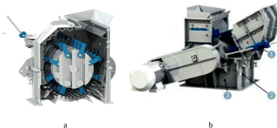
Rys. 4.3. Kruszarka młotkowa z rusztem produkcji firmy Makrum [12]: a – widok strefy kruszenia, b – widok kruszarki z otwartą obudową: 1 – blokada położenia obudowy, 2 – pokrywa rewizyjna, 3 – ruszt
