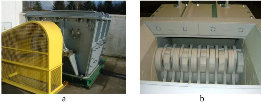
Rys. 4.31. Kruszarka młotkowo-pierścieniowa firmy Fugor S.A [44]: a – widok kruszarki od strony napędu, b – widok strefy kruszenia kruszarki
