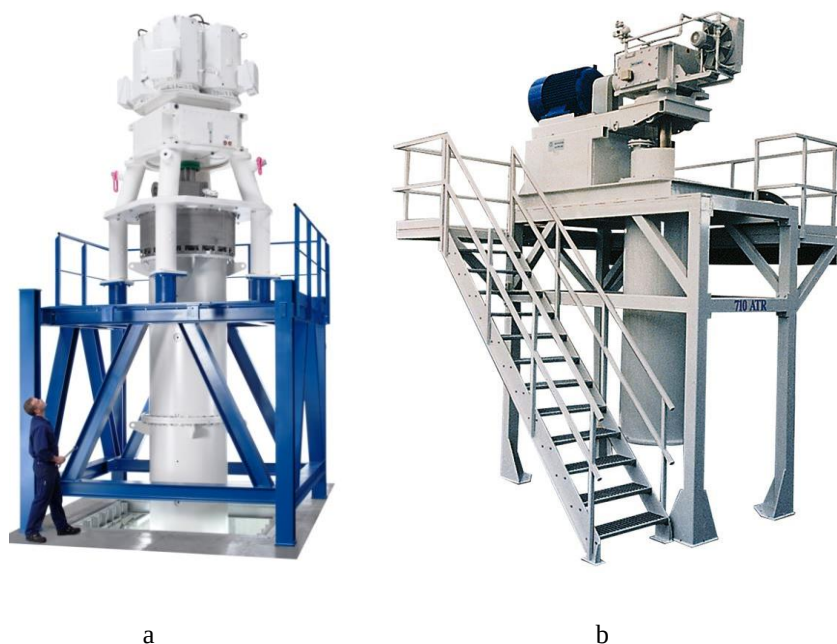
Rys. 7.7. Rozwiązania konstrukcyjne młynów firmy Alpine: a – typ ATR do mielenia na sucho, b – typ ANR – do mielenia na mokro bez zanieczyszczeń metalicznych (z udziałem ceramicznych elementów roboczych mielników, elementów wirników i wykładzin komory) [29]
