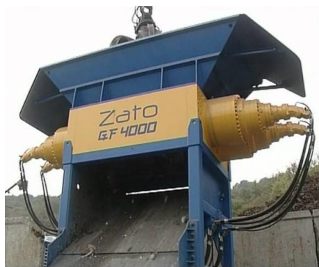
Rys. 3.22. Kusrzarka ( shredder ; strzępiarka) firmy Zato model GF 4000: a – widok, b - strefa i nóż rozdrabniający [41]
