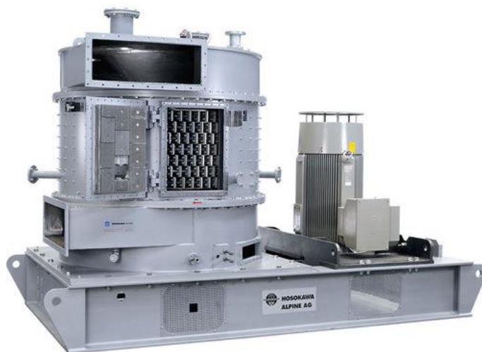
Rys. 12.17. Młyn bijakowy firmy Hosokawa Alpine z pionowym wirnikiem turbinowym [20]
