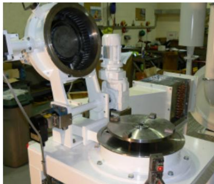
Rys. 12.26. Młyn bijakowy z separatorem w wykonaniu specjalnym z otwieraną wykładziną komory montowaną w pokrywie [27]
