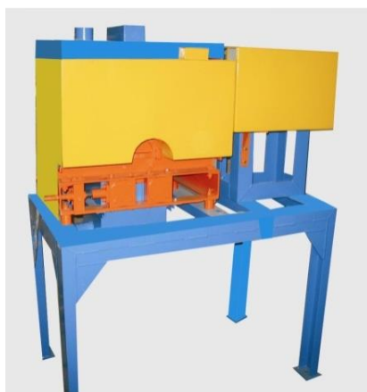
Rys. 5.9. Wibracyjna kruszarka VC-E-9x30 do rozdrabniania nadwymiarowych ziaren w przemyśle chemicznym (Foto J. Sidor)
