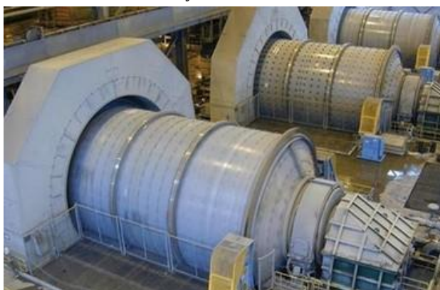
Rys. 6.8. Młyny kulowe firmy FLSmidth do mielenia rud na mokro - \phi 7,9 \times 12,3 m o mocy 16,4 MW z napędem silnikiem wieńcowym [32]
