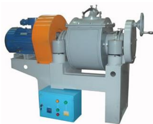
Rys. 8.9. Młyn jednokomorowy o działaniu ciągłym typ MWO-50 do mielenia na sucho i na mokro mas i szkliw ceramicznych [41]
