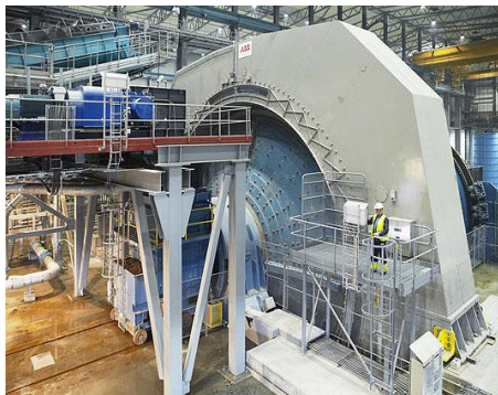
Rys. 6.27. Młyn SAG z napędem firmy ABB, moc 35 MW, średnica komory 13,4 m [54]
