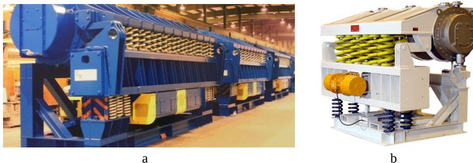
Rys. 8.14. Młyny wibracyjne firmy General Kinematics: a - w linii technologicznej w przemyśle górnictwa, b - jeden z prototypów młyna [38, 48]
