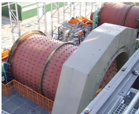
Rys. 6.29. Młyny SAG firmy Thyssen Krupp Polysius, komora: średnica 7,9 m, długość 11,7 m [56]
