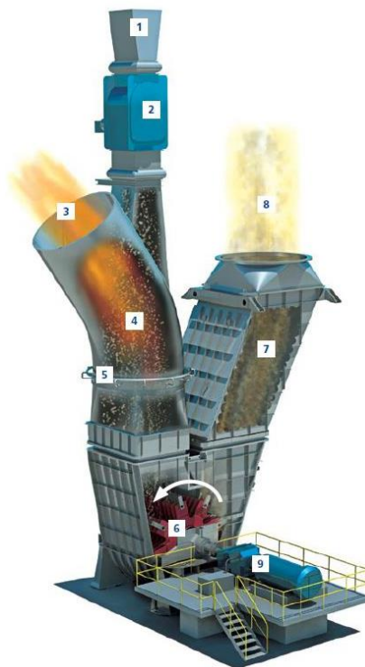
Rys. 5.16. Suszarko-krusarka młotkowa firmy FLSmidth [27]: wlot nadawy, 2 - śluza obrotowa, 3 - wlot gorących gazów, 4 - rura mieszania, 5 - dysza, 6 - wirnik, 7 - kanał odprowadzający, 8 - odbiór produktu rozdrabniania, 9 - napęd
