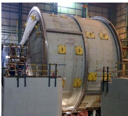
Rys. 6.28. Młyn SAG firmy FLSmidth, komora średnica 12,2 m, długość 7,9 m, moc 28 MW, wydajność 3425 Mg/h, napęd centralny [55]
