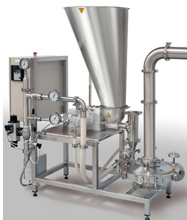
Rys. 14.8. Układy mielenia młyna strumieniowo-spiralnego [15]: a - MCJet Mill 200, b - MC Dec 400
