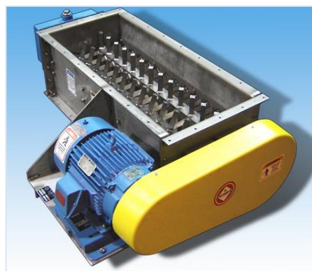
Rys. 3.21. Kusrzarki jednawalcowe: a – ścianowa [46], b - rozbrylacz [32]
