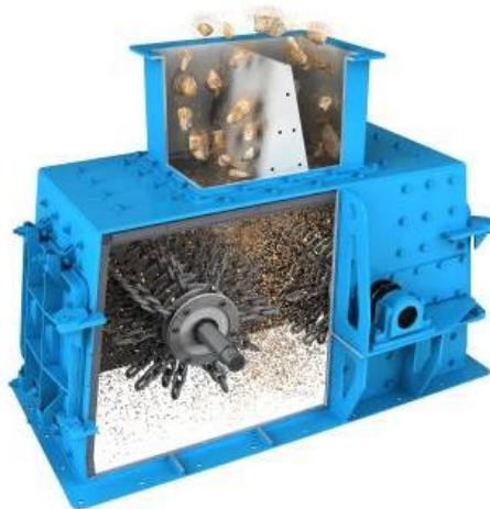
Rys. 4.32. Kuszarka łańcuchowa w wersji dwuwirnikowej [45]
