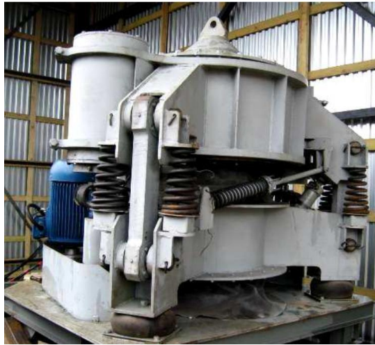
Rys. 5.14. Stożkowa kruszarka wibracyjna WKDC-700 z napędem stożka zewnętrznego [18]
