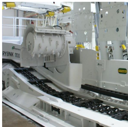
Rys. 3.21. Kusrzarki jednawalcowe: a – ścianowa [46], b - rozbrylacz [32]
