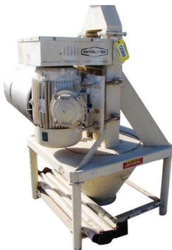
Rys. 13.10. Młyn entoleter serii 27-2 CBP o mocy 37 kW i prędkości obrotowej wirnika 1735 obr/min - firmy Entoleter [20]
