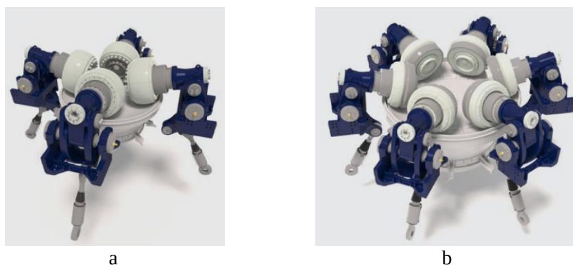
Rys. 10.13. Budowa układu rozdrabniania (rolka-misa) młyna OK firmy FLSmidth: a – czterorolkowy do mielenia surowców, b – sześciorolkowy do mielenia cementu [30]
