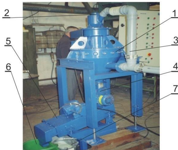
Rys. 13.15. Prototypowy młyn wirnikowy MW-300 – podczas wstępnych prób mielenia: 1 - młyn, 2 - króciec wlotu nadawy, 3 - przewody recyrkulacji powietrza, 4 - podajnik celkowy, 5 - przesiewacz wibracyjny, 6 - pojemnik nadziarna, 7 - pojemnik gotowego produktu [26] (Foto J. Sidor)
