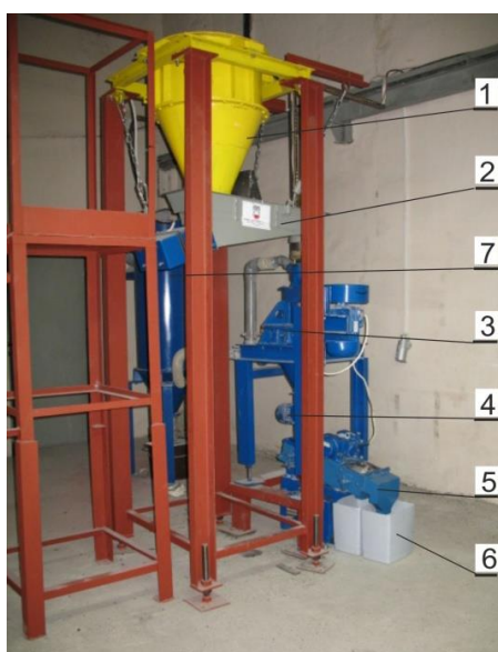
Rys. 13.17. Prototypowa linia technologiczna: 1 - zbiornik nadawy, 2 - podajnik wibracyjny, 3 - prototypowy młyn wirnikowy MW-300, 4 - podajnik celkowy, 5 - prototypowy przesiewacz wibracyjny PW-90, 6 - zbiorniki produktu mielenia i nadziarna, 7 - filtr powietrza [26] (Foto J. Sidor)
