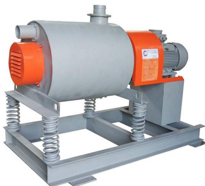
Rys. 8.8. Młyn jednokomorowy o działaniu ciągłym typ MW-400 do mielenia na sucho do mielenia wysokiej jakości cementów [40]
