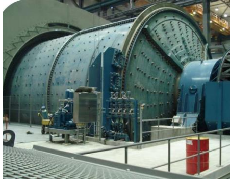
Rys. 6.24. Młyn AG firmy Metso, komora \phi 11,6x 13,7 m, moc 22,5 MW [51]
