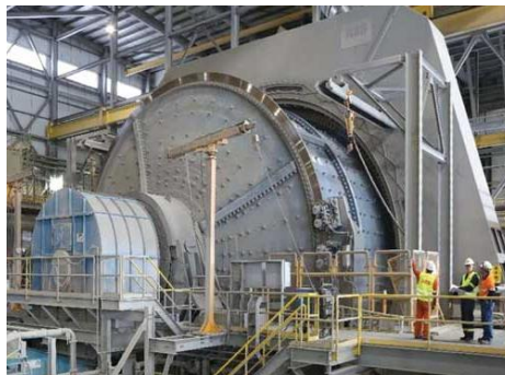
Rys. 6.26. Młyn AG firmy E&MJ, średnica komory 12,2 m, moc 23,5 MW [53]
