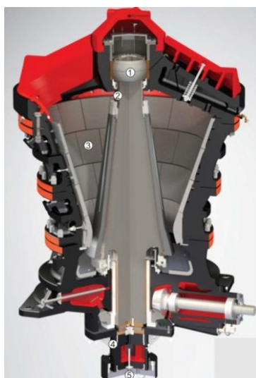
Rys. 3.37. Kruszarka stożkowa firmy Sandvik [60]: 1 – przegub, 2 – stożek, 3 – stożek zewnętrzny, 4 - tłok, 5 – wlot medium
