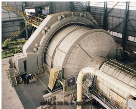
Rys. 6.25. Młyn SAG –firmy Metso z napędem bezprzekładniowym [52]
