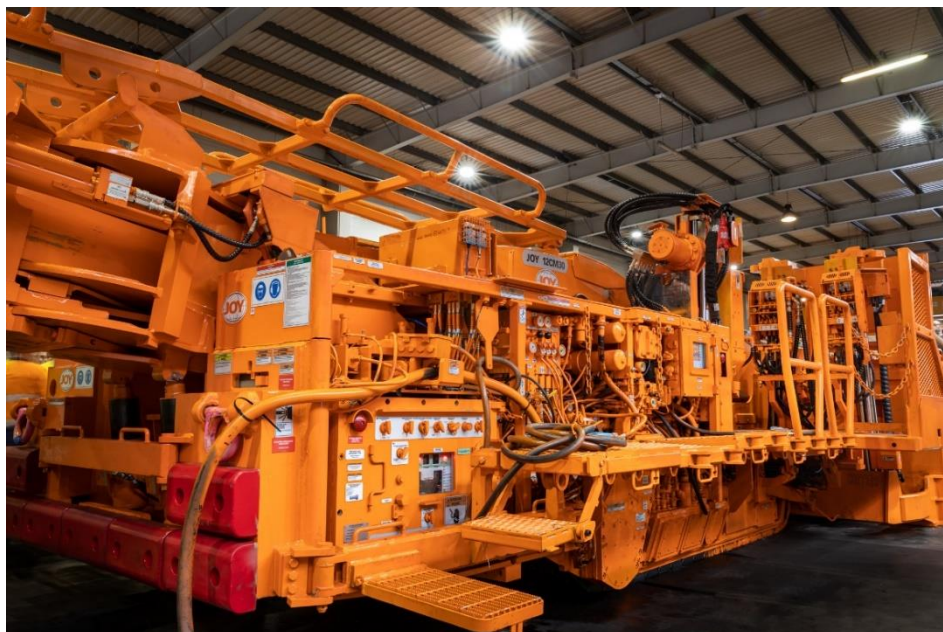
Fot. 4.4. Kombajn JOY 12CM30 w zakładzie Joy Global w Tychach – systemy sterowania
