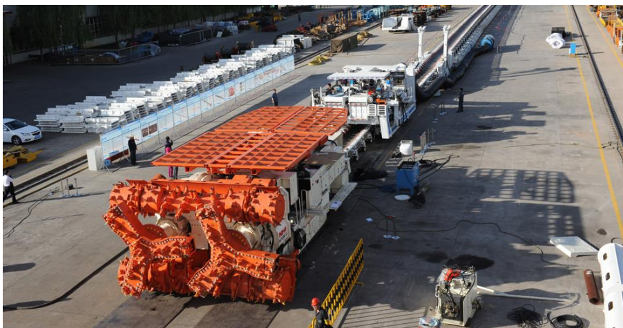
Fot. 2.6. Pełnoprzekrojowy kombajn chodnikowy typu QMJ4260 do szybkościowego drążenia chodników węglowych i wielogłowicowa kotwiarka mobilna w kopalni Daliuta [32]
