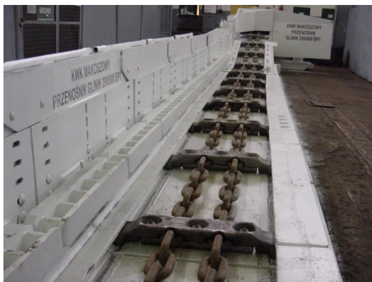
Rys. 4. Widok przenośnika zgrzeblowego [86]
