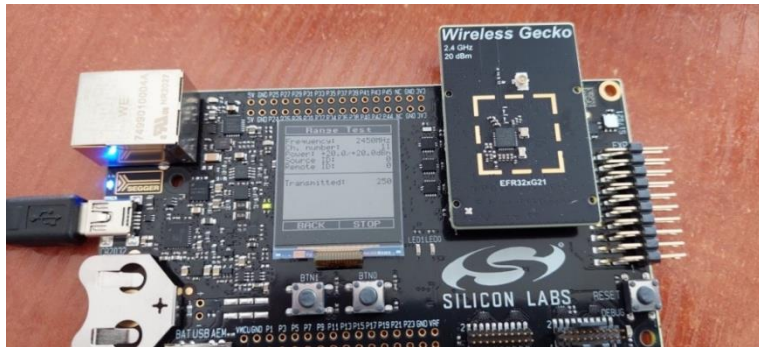
Rys. 48. Widok modułu radiowego EFR32XG21 (skonfigurowany jako nadajnik)
