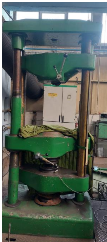
Rys. 90. Stanowisko do badań na ściskanie obudów węzłów sieci sensorycznej
