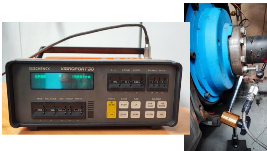
Rys. 23. Bezstykowy pomiar prędkości obrotowej wału silnika spalinowego [45]
