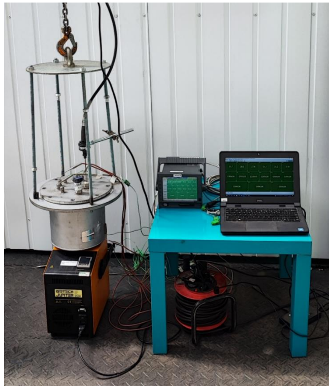
Rys. 25. Widok ogólny stanowiska do badań rurek ciepła [45]
