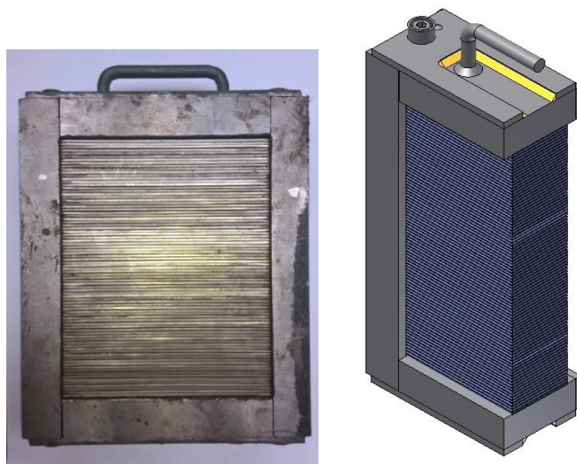
Rys. 5. Przerwywacz płomienia górniczego spalinowego układu napędowego [16]
