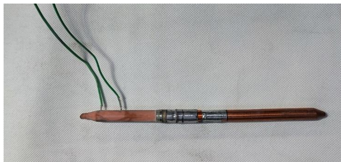
Rys. 26. Rurka ciepła z termoparami na zewnątrz sekcji skraplacza [45]
