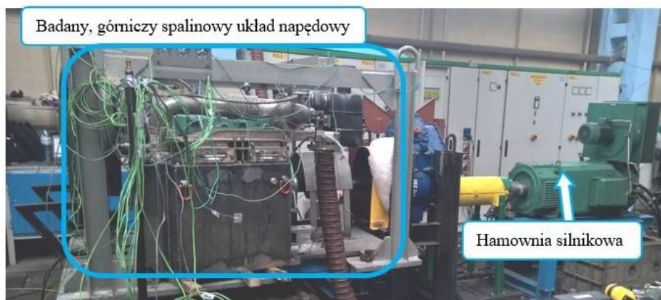
Rys. 17. Stanowisko ITG KOMAG do badań górniczych spalinowych układów napędowych [45]
